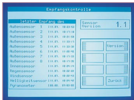
Bild 10: Schnelle Übersicht über die Empfangssituation - die Empfangskontrolle.
