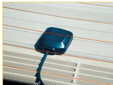
Bild 23: Einfache Montage: Die GPS-Antenne im Heckfenster
