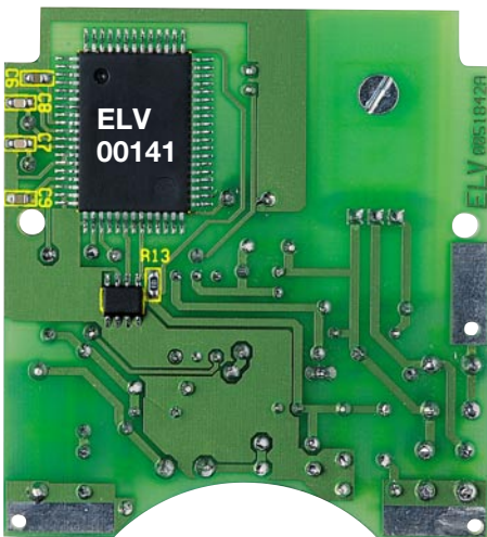
Ansicht der fertig bestückten Platine des Dimmers SO 100 mit zugehörigem Bestückungsplan (oben: Bestückungsseite, unten: Lötseite)
