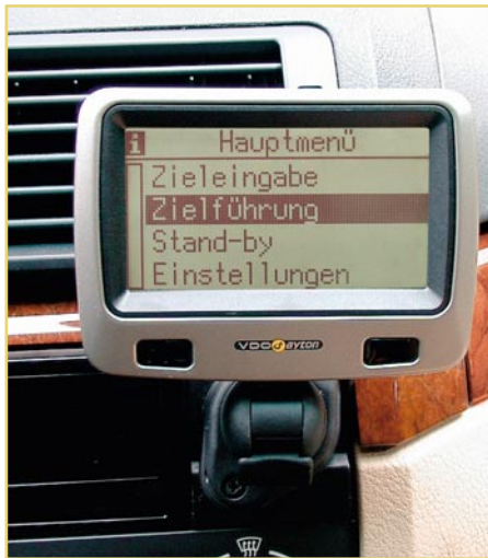
Bild 19: Der Monitorfuß ist universell montier- und in zwei Achsen schwenkbar.
