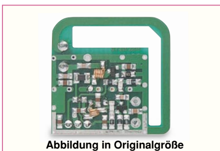
Bild 2: Das kompakte Sendemodul HFS 300. Die Sendeantenne ist als Leiterschleife ausgebildet.
