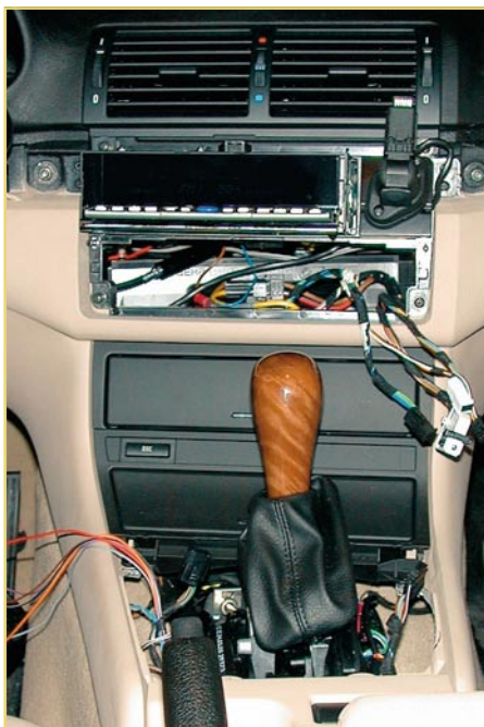
Bild 22: Für die ordnungsgemäße Kabel-Verlegung sind nur wenige Teile zu lösen, die zumeist nur gesteckt sind. Hier ist zur einfacheren Montage auch das Bedienteil der Klimaanlage vom Radioschacht aus herausgedrückt worden.
