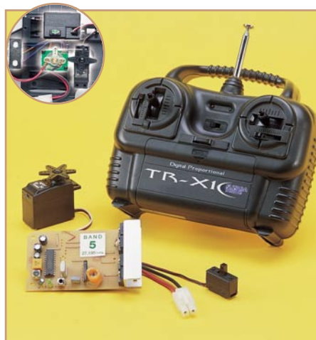
Bild 3: Spart Gewicht und einen teuren Elektronik-Fahrtregler - das E-Power-RC-Set mit integriertem Fahrtregler
