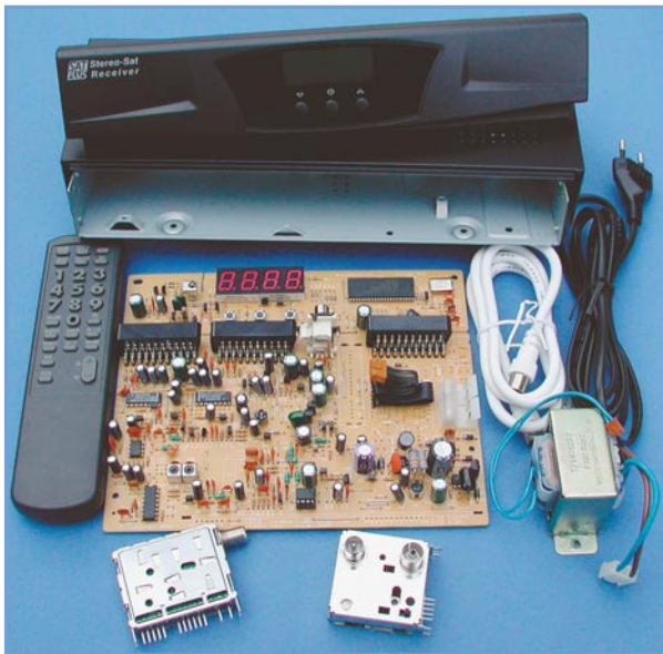
Bild 1: So wird der Bausatz geliefert. Dazu kommen noch das Montagematerial, Bedienanleitung und Frequenztafel.
