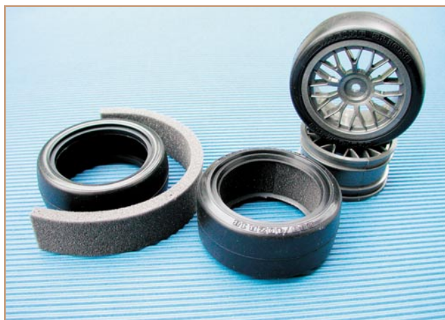
Bild 12: Reifenmontage - links: Lieferzustand mit Einlage, in der Mitte ist die Einlage bereits sauber platziert und rechts ist ein fertig montiertes und verklebtes Rad zu sehen.
