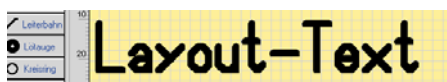
Bild 5: Als Leiterbahn generierter Text hat den Vorteil, vom Gerber-Ausgabeformat unterstützt zu werden.
