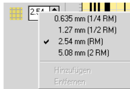
Bild 6: Die Containerfunktion ermöglicht auch das Abspeichern eigener Leiterbahnbreiten, Rasterweiten und Löttaugenabmessungen.
