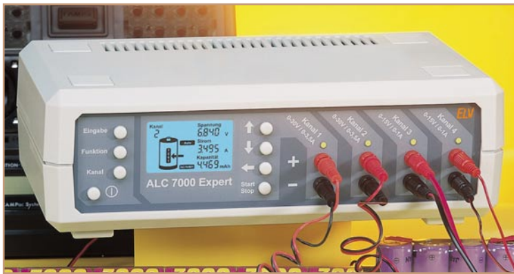
Bild 6: HighTech-Lader - komplexes Ladegerät für das gleichzeitige Laden, Entladen und Warten mehrerer, auch verschiedener Akkus.
