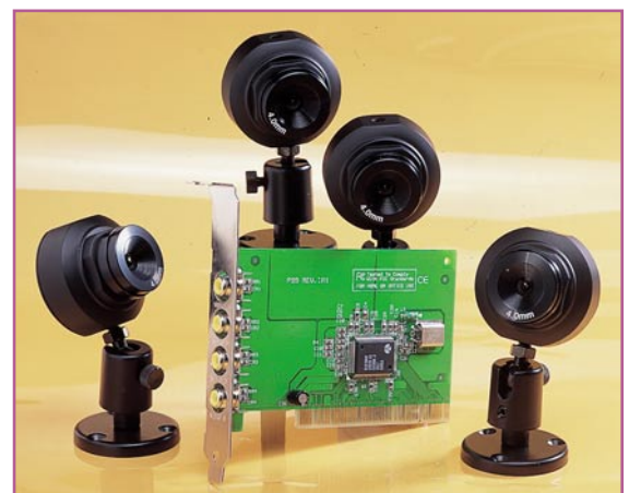
Bild 1: Bereit für den Anschluss von vier Kameras, die ein Composite-Videosignal ausgeben - die Capture-Karte.
