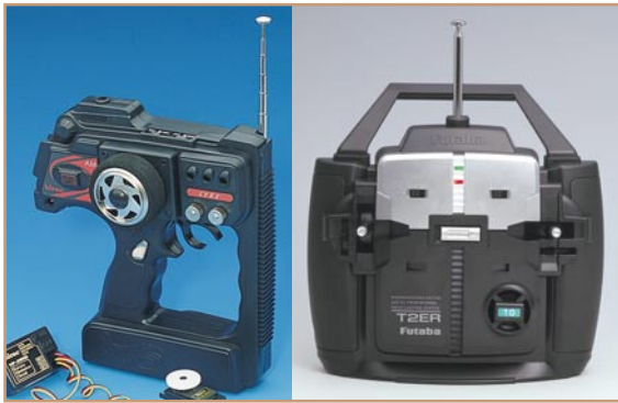
Bild 1: Zwei typische Vertreter von preiswerten 2-Kanal-Fernsteueranlagen. Die in Pistolenform ist besonders für die Steuerung von Fahrzeugen prädestiniert.
