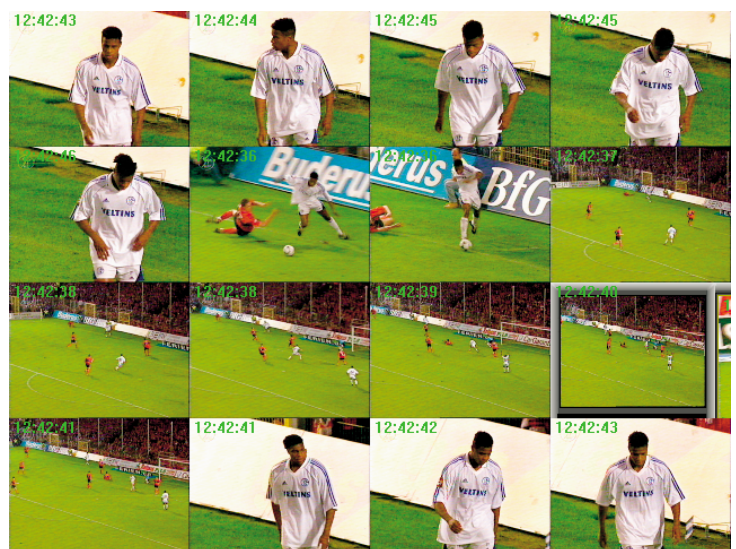
Bild 13: Hier erkennt man die Wirkung der Empfindlichkeitseinstellung deutlich, bei 10% Veränderungsschwelle kommen sehr viele Aufnahmen zustande.
