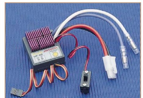
**Bild 23: Ein elektronischer Fahrtregler sorgt für höchsten Steuerkomfort.**
