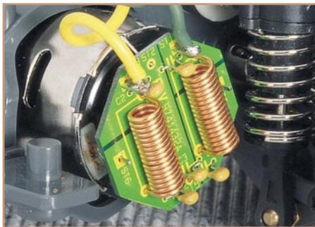
**Bild 13: Optimale Lösung - ein komplettes Entstörfilter, passend an alle Elektromotoren der 540er-Reihe.**
