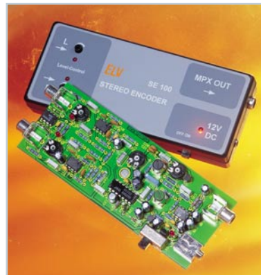
◀ Stereo- Encoder SE 100 Bildet aus einem NF-Stereosignal ein Stereo-Multiplexsignal Seite 6
