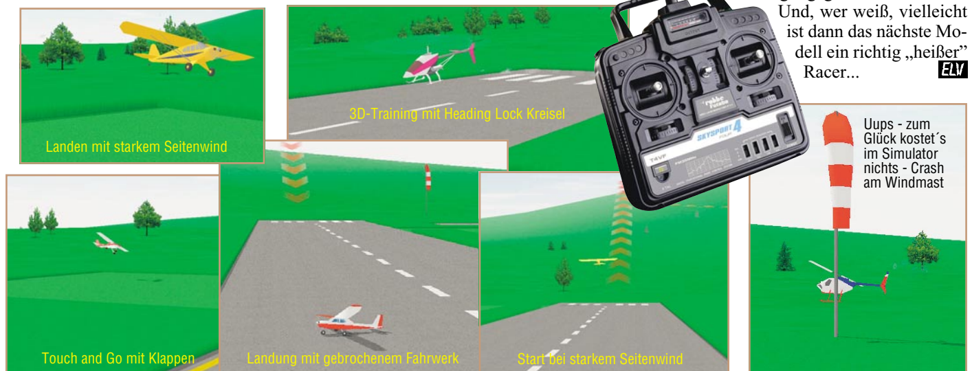
Bild 36: Der Flugsimulator „REFLEX“ erlaubt das Trainieren am Computer mit der eigenen Original-Fernsteuerung, sofern diese über eine Lehrer-Schüler-Buchse verfügt.
