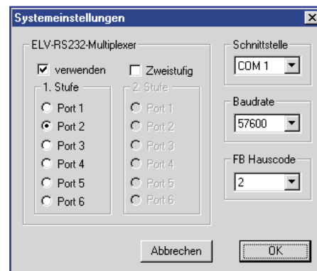
Bild 6: Das Einstellfeld für die Systemeinstellungen. Links das Einstellfeld bei Einsatz des ELV-RS-232-Multiplexers, rechts die Felder für die Wahl der PC-Schnittstelle, der Übertragungsraten und des Bedienstatus der Funk-Fernbedienung.
