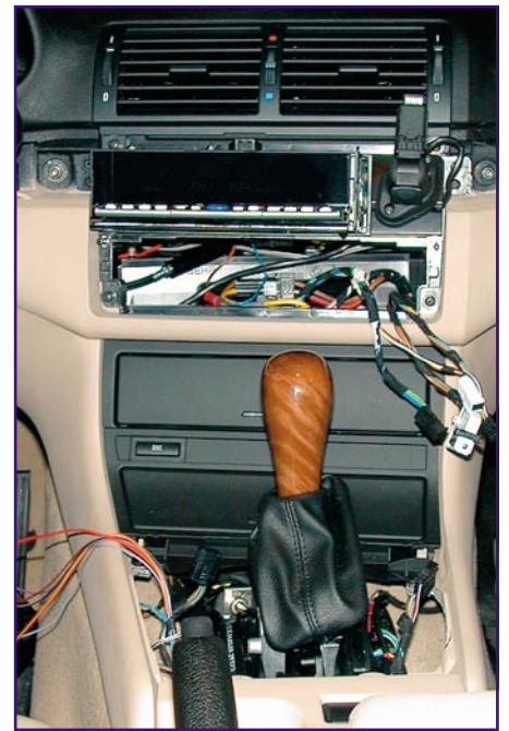
Bild 26: Wenn möglich, alles ringsum abbauen - hier wurde das Steuerteil der Klimaanlage entfernt, um das Radio besser einbauen zu können.
