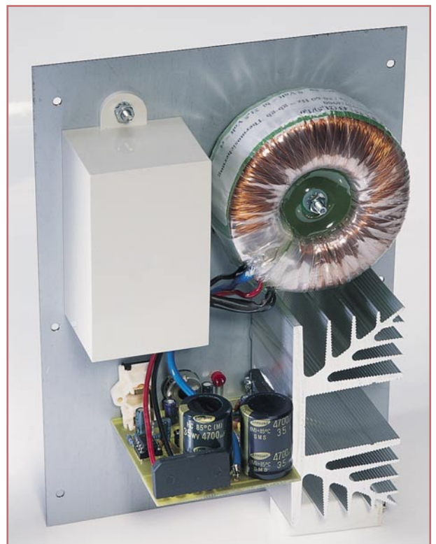
Ansicht des Einbauverstärkers VM 32 von der Rückseite
