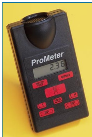
Bild 1: Für das bequem zu erstellende Aufmaß haben sich solche Ultraschall-Messgeräte bereits fest etabliert.
