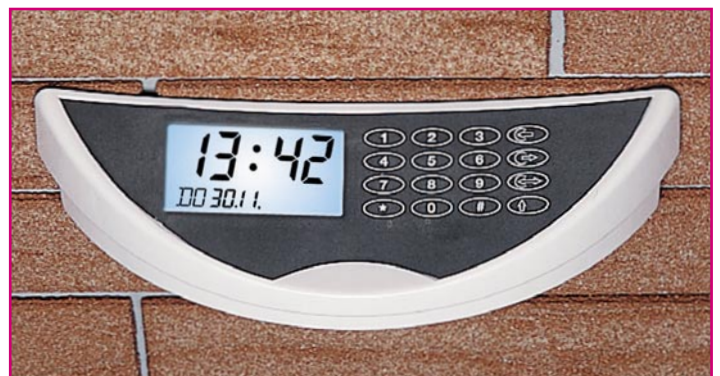
Bild 7: Robuste Außeneinheit mit großem LC-Display und weitgehend vandalismussicherer Folientastatur
