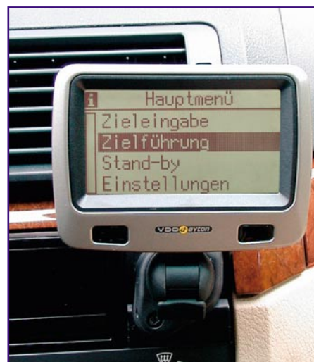
Bild 25: Passt: Die Radioblende sorgt für optische Anpassung und trägt den Monitor des Navigationssystems.
