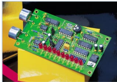
◀ 2-Kanal- Temperaturanzeige und Lüfter- steuerung Überwachung und Temperaturanzeige für 2 Messpunkte im PC mit Lüfteransteuerung für 2 Lüfter Seite 26
