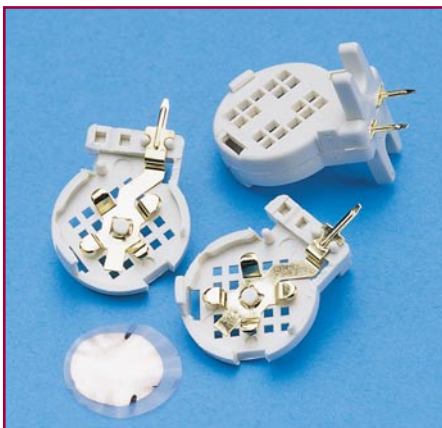
Bild 2: Valvo-Feuchtesensor im geöffneten und geschlossenen Zustand
