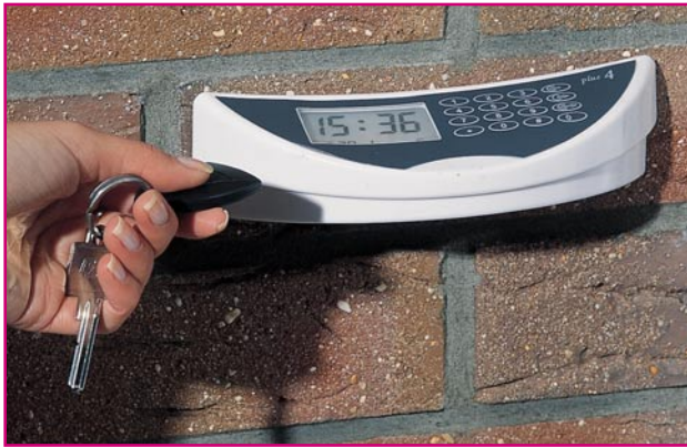
Bild 6: Bequem und sicher - kontaktlose Auslösung über den Transponder
