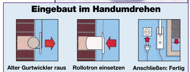
Bild 23: Klimasteuerung mit Rollläden: Einfach nachzurüstender Unterputz-Rollladenantrieb.
