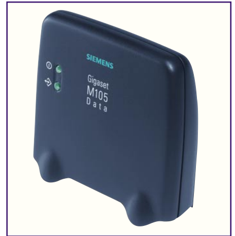
Bild 26: Datenübertragung ohne Kabel: DECT-Technik sorgt für die Überbrückung der Entfernung zwischen PC-Modem und Telefonsteckdose.
