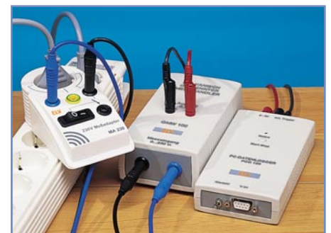
Bild 8: Aufzeichnung der Netzspannung mit dem Datenlogger PCD 100 über den MA 230 und dem GMW 100
