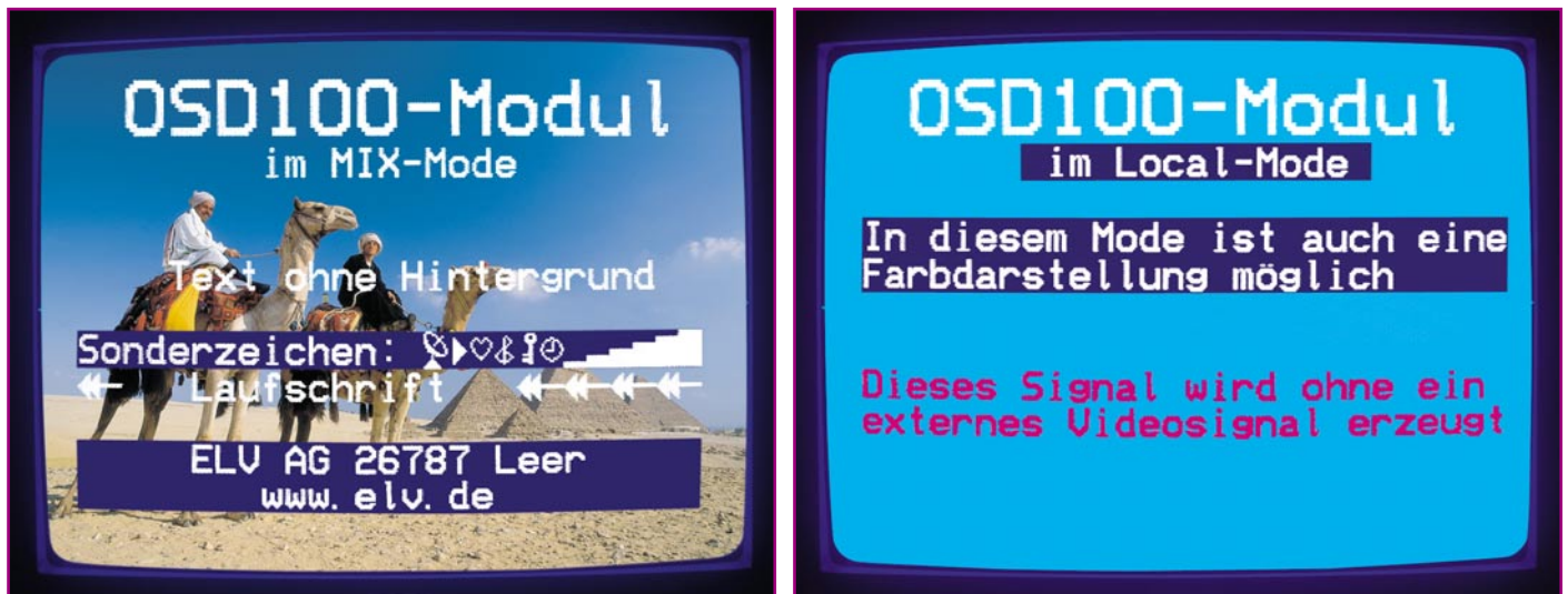
Bild 6: Die Bildschirmfotos zeigen die beiden möglichen Betriebsarten des OSD 100-Moduls: Mix-Mode und Local-Mode (Erläuterung siehe Text).
