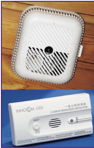
Bild 24: Warnen vor Bränden und Gasen: Rauchmelder und Gasmelder.
