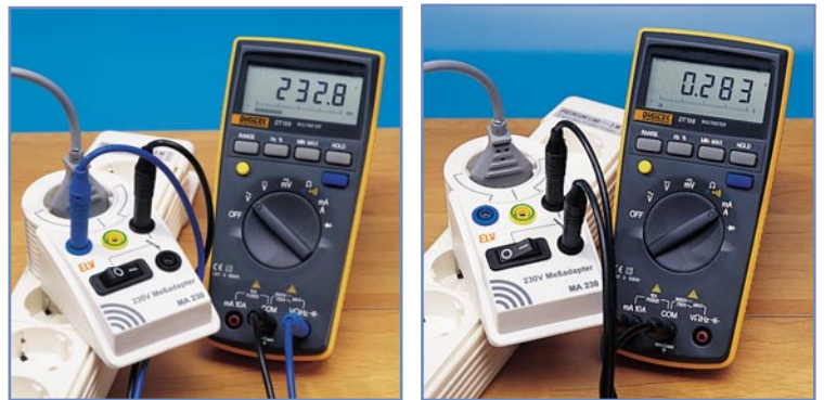
Bild 7: Der MA 230 in der Anwendung, links Spannungsmessung, rechts Strommessung
