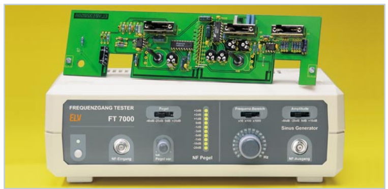
▲ Frequenzgang-Tester FT 7000 Vielseitige Kombination aus Pegeltongenerator (20 Hz bis 20 kHz variabel) und VU-Meter (-20 dB bis +3 dB) Seite 39
