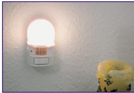
Bild 14: Kein Strom - kein Problem: Automatische Nachtleuchte mit Bewegungsmelder, Dämmerungsschalter und Akkubetrieb.
