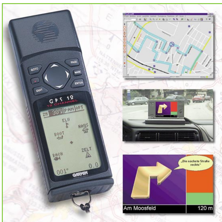
Bild 2: Ein GPS-Empfänger mit NMEA-Schnittstelle kann auch mit dieser Schnittstelle versehene Routenplaner mit Positionsdaten versorgen.
