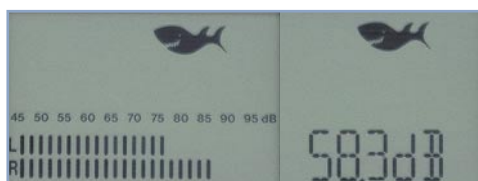
Bild 3: Pegelanzeige in Echtzeit, wahlweise analog oder digital
