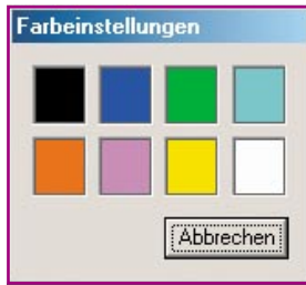
Bild 4: Diese Farben stehen für Zeichenfarbe, Zeichenhintergrund, Bildhintergrund und Zeichenrand zur Verfügung.
