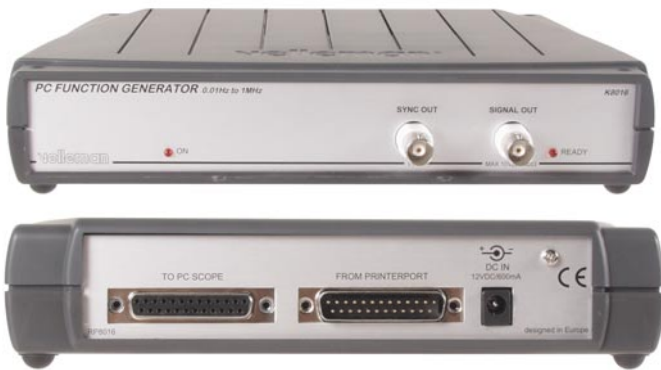
Bild 9: Bietet sich für den Systemausbau an: PC-Funktions-generator PCG 10.
