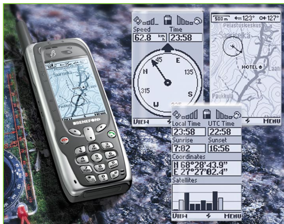
Bild 12: Das Highlight der Handy-GPS-Szene - Benefon ESC mit integriertem GPS-Empfänger und Karten-Routenführung.
