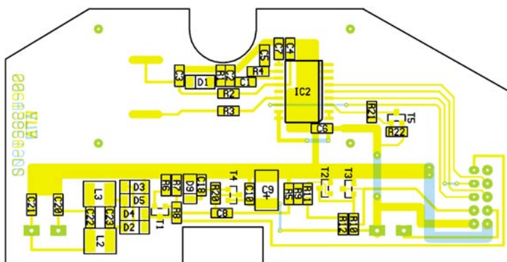
Ansicht der fertig bestückten Transponderplatine mit zugehörigem Bestückungsplan, oben von der Bestückungsseite, unten von der SMD-Lötseite
