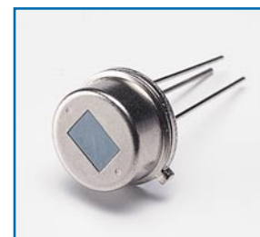
Bild 1: Typische Bauform von PIR-Sensoren
