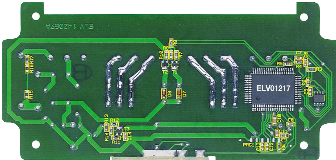
Ansicht der fertig bestückten Platine der Markisensteuerung FS 10 MS mit zugehörigem Bestückungsplan von der Lötseite
