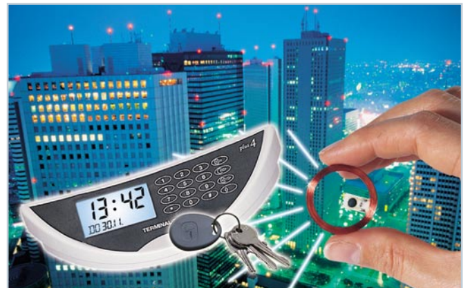
▲ Profi-Zugangskontrollsystem TAC 100 Universelles, einfach zu installierendes Zugangskontrollsystem für die Bedienung mit bis zu 15 drahtlosen Transpondern und/oder Zahlencodes Seite 65
