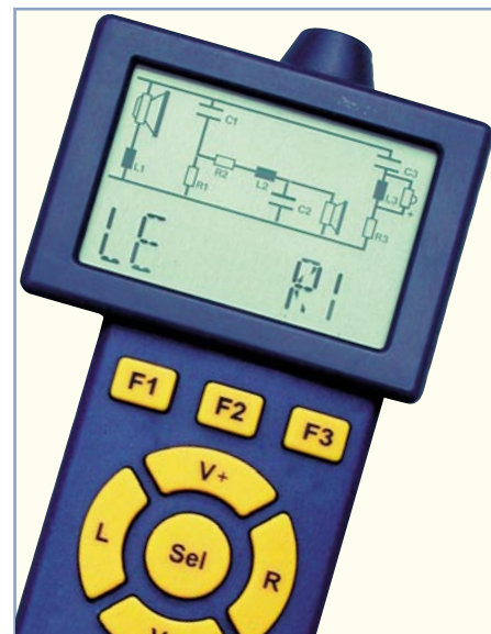
Bild 1: Der AC in Aktion, hier bei der Programmierung einer Frequenzweiche
