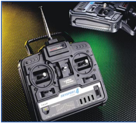
Bild 4: Typische 4-Kanal-Anlage mit Lehrer-Schüler-Buchse - für die meisten Simulatoren einsetzbar.
