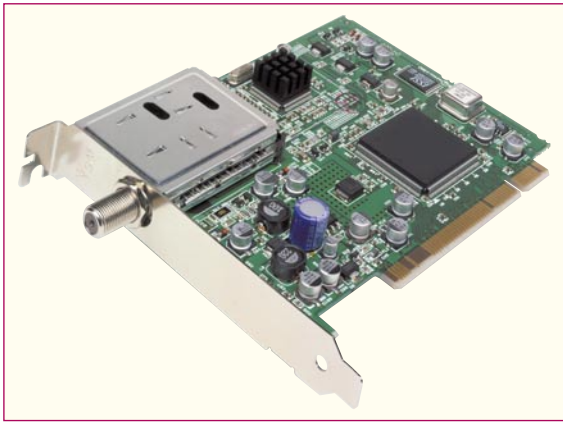
Bild 3: Digitaler Sat-Receiver auf der PCI-Karte - hervorragend geeignet für das Downloaden großer Datenmengen aus dem Internet
