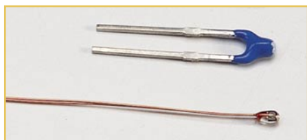
Bild 4: Verschiedene Bauformen eines von den Daten identischen Temperatursensors
