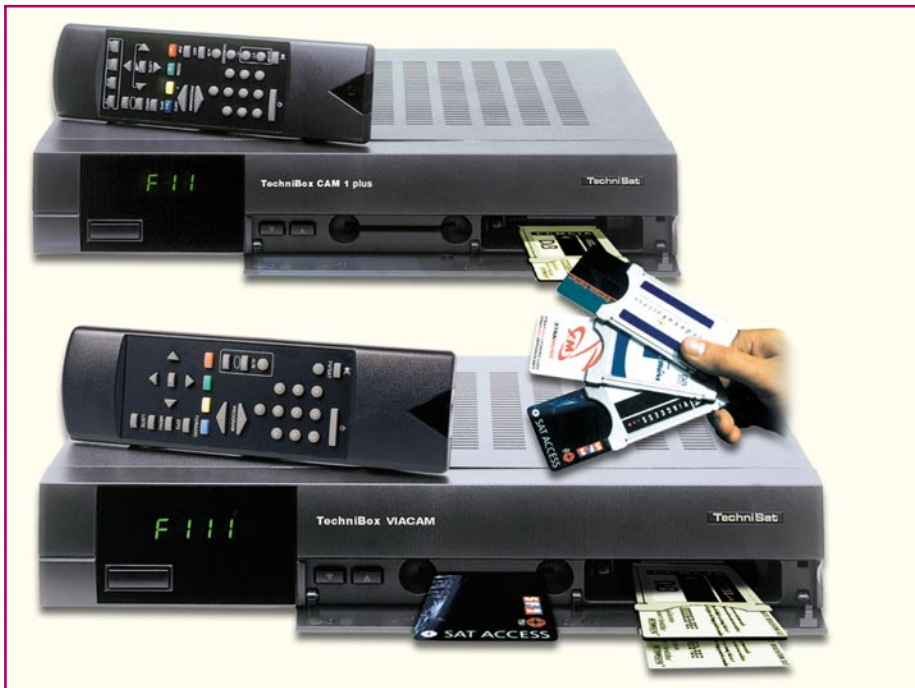
Bild 1: Zukunftssichere Investition: Digitale Sat-Receiver mit Modulschächten für den diskriminierungsfreien Empfang von Pay-TV und Pay per View
