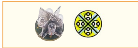
Bild 3: Ansicht der fertig bestückten Leuchteneinheit der Rundumleuchte mit zugehörigem Bestückungsplan
