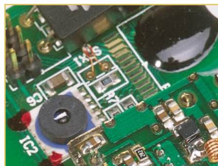
Bild 13: Moderne piezo-resistive Drucksensoren finden Einsatz in den Innensensoren der ELV-Funk-Wetterstationen
