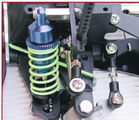
Bild 10: An den Stoßdämpfern ist die Federungscharakteristik einstellbar.
