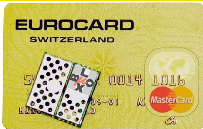
Bild 1: Der Größenvergleich mit der in Originalgröße dargestellten Kreditkarte zeigt, wie kompakt GPS-Module, hier das wohl derzeit kleinste der Welt von \mu -Blox sein können. Der Screenshot unten zeigt, wie exakt das Modul arbeitet. Bilder: \mu -Blox
