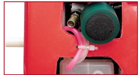
Bild 5: Hier sind die beiden Tank-schläuche gut aufgehoben. Links ist auch der dicke Silikonschlauch zu sehen, der die Abgase nach außen ableitet und so eine Verschmutzung der Karosserie und der Reifen verhindert.
