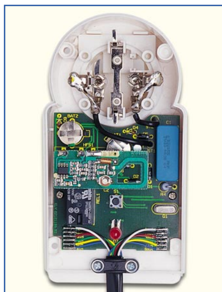
Bild 12: Ansicht der fertig verdrahteten FS 10 TFT-Einheit im Gehäuse
