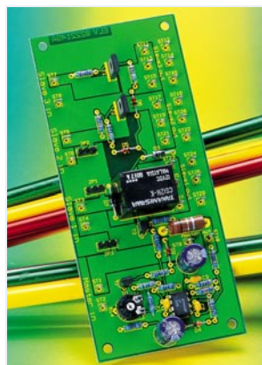
▲ Master-Slave für Niederspannung Für das gleichzeitige Ein- oder Ausschalten von mehreren Niederspannungsverbrauchern, ausgelöst durch einen Master-Verbraucher Seite 23
