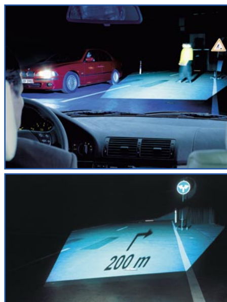
Bild 13: Könnte eine Revolution in der Scheinwerfertechnik werden: das Pixellicht. Es leuchtet wichtige Objekte mit beweglichen Minispiegeln gezielt an, Blendung des entgegenkommenden Fahrers wird vermieden und es lassen sich Fahrerinformationen direkt in den Lichtkegel einblenden. Bild: BMW
