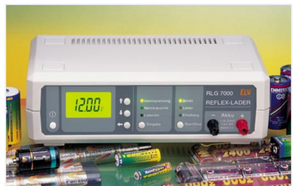
▲ Reflex-Lader RLG 7000 Hochleistungs-Ladegerät nach dem Reflex-Ladeverfahren - lädt mit Raten bis zu 4 C Seite 42
