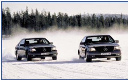
Bild 1: ESP verhindert erfolgreich das Ausschwenken des Hecks bei Kurvenfahrt oder glattem Untergrund. Links ohne, rechts mit ESP. Bild: DaimlerChrysler
