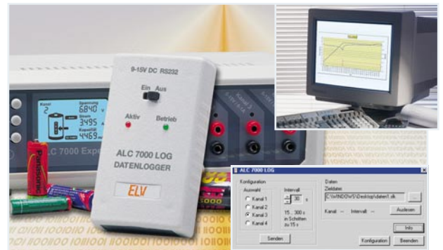
▲ Datenlogger ALC 7000 LOG Speichert vom Profi-Ladegerät ALC 7000 Expert erfasste Akku-Daten und gibt sie an einen PC zur Verarbeitung weiter. Teil 2: Die Software Seite 68
