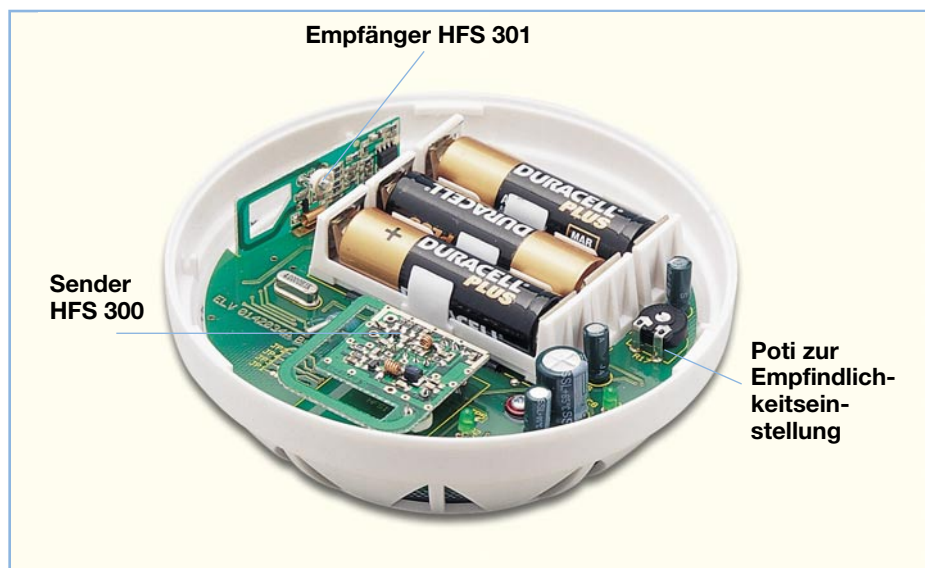
Bild 7: Wichtige Bestandteile des Funk-Rauchmelders
