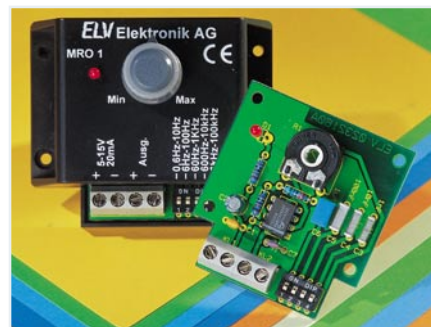
▼ Mini-Rechteckoszillator Praktischer Alltagshelfer in Labor und Service: 0,6 Hz bis 10 kHz in 5 Bereichen Seite 18
