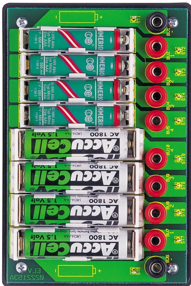
Ansicht der fertig bestückten Platine des Akku-Lade-/Speiseadapters für Mignon-/Mikro-Zellen (Originalgröße: 135 x 90 mm)
