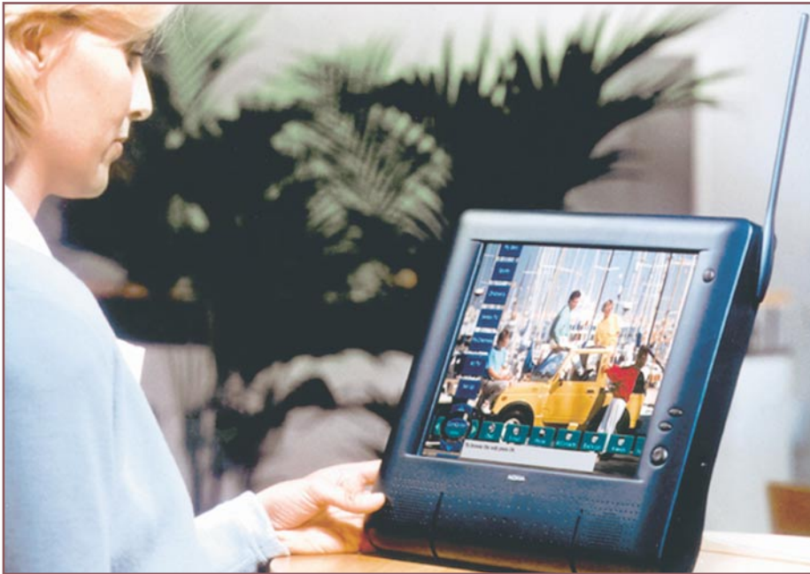
Bild 2: Die Zukunft des terrestrischen Fernsehens - Nokia zeigt mit dem „Mediascreen“, wie es aussehen wird. Mit dem digitalen Home Terminal kann man Radio hören und fernsehen, E-Mails und SMS verschicken/empfangen und sogar im Internet surfen. Das System funktioniert sowohl stationär als auch mobil.
