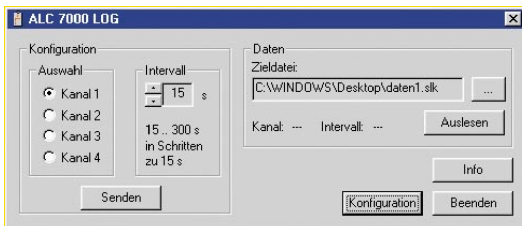
Bild 2: Im Hauptfenster der PC-Software ist das Setzen der Erfassungsparameter für den Datenlogger ebenso möglich wie das Konfigurieren der Schnittstelle, die Auswahl des Speicherortes für die ausgelesenen Daten und das Auslesen der Daten selbst.
