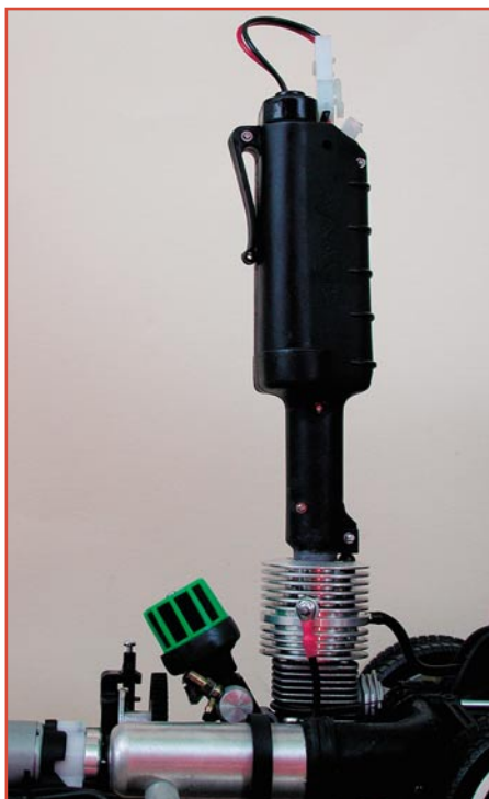
Bild 8: Der Motorstart erfolgt über solch ein Startgerät.
