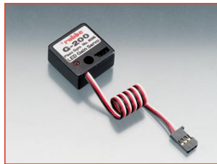
Bild 3: Auch in Kreiselssystemen für Modell-Helikopter arbeitet ein kleiner Giersensor.
