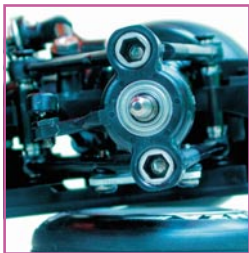
Bild 9: Profi-Fahrwerk - Kugellager und elegante Verstellmöglichkeiten an der Achse des F 201
