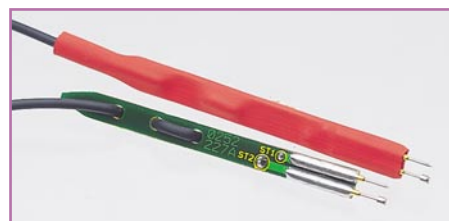
Bild 5: Spezial-Messleitungen mit federnd gelagerten Messspitzen.
