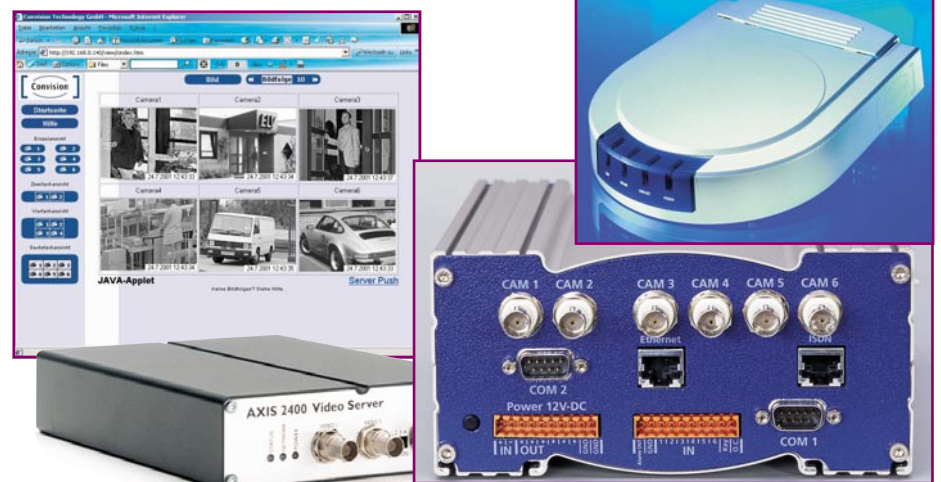
Bild 3: Für den Anschluss analoger Kameras - kleine, universell nutzbare Video-server, hier von AXIS (links) und Convision (rechts)
