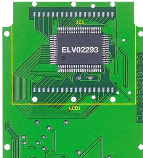
Ansicht der fertig bestückten Platine des SPM 100 mit zugehörigem Bestückungsplan, oben ein Teilausschnitt von der Displayseite, unten komplett von der Lötseite
