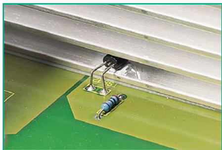
Bild 11: Montage des Temperatursensors TS 502 im Kühlkörper
