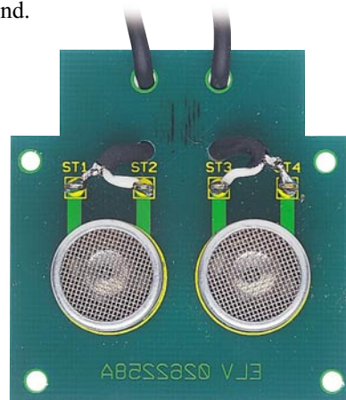
Ansicht der fertig bestückten Sensorplatine mit zugehörigem Bestückungsplan
