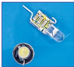
Bild 4: Miniaturplatine mit einer LED in E-10-Fassung
