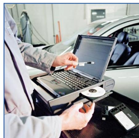
**Bild 3: Update über Laptop per CD-ROM oder Internet - heute schon Realität in den Werkstätten. Bild: Daimler Chrysler**
