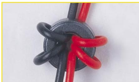
**Bild 4: Fertig gewickelte stromkompensierte Ringkerndrossel**
