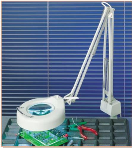
**Bild 13: Eine gute Lupenleuchte hilft beim Platzieren und Löten.**
