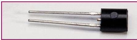
**Bild 2: Temperatur-Sensor KTY81-121**
