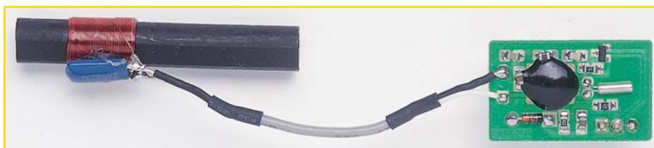
Bild 3: So wird das DCF-Modul vorbereitet
