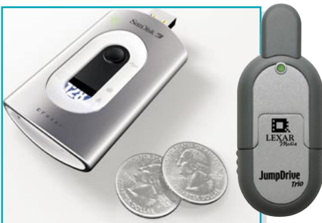
Bild 14: Upgradebare USB-Speicher erlauben das Einlegen normaler Speichermodule und den Direktanschluss an den USB. Bild: SanDisk/ Lexar
