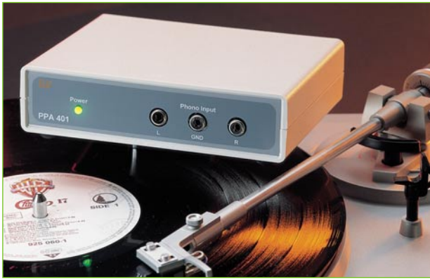
Bild 1: Für Plattenspieler mit einem Magnet-Abtastsystem wird ein solcher Phono-Entzerrer benötigt.
