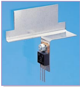
Bild 4: Die Montage des Kühlkörpers
