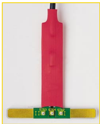
Bild 6: Sensor- platine mit Schrupf- schlauch
