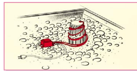
Bild 2: Frostschutz an Flachdachabläufen und Gullys
