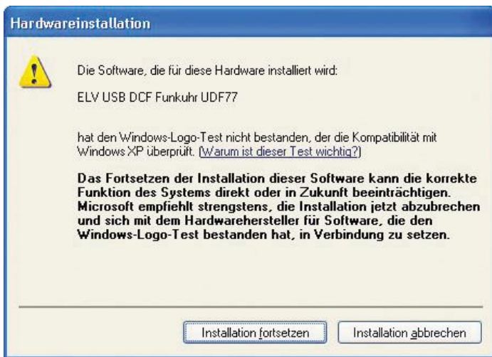
Bild 4: Die Hardwareerkennung erfolgt zusammen mit dem mitgelieferten Treiber automatisch. Die Logo-Abfrage von Windows XP kann man übergehen.
