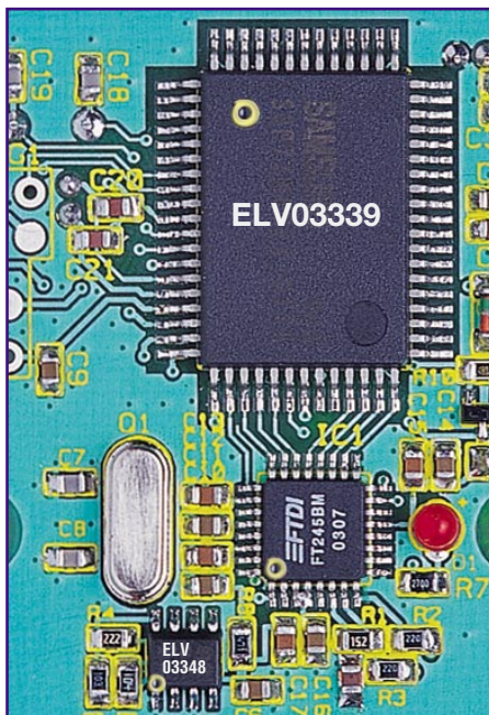
Bild 2: Die richtige Einbaulage der ICs, Pin 1 ist hier jeweils markiert.
