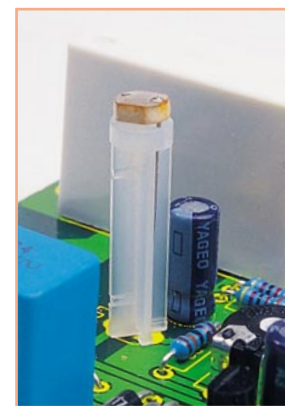
Bild 2: Seitliche Ansicht des eingebauten Fotowiderstands mit Abstandshalter
