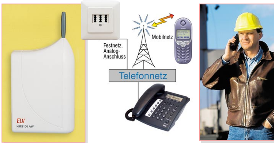
Bild 5: Der Telefon-Alarmwähler wählt automatisch bis zu drei Nummern an, um einen Alarm mitzuteilen
