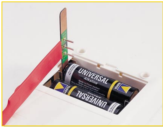
Bild 1: So wird der Streifen zwischen Batteriekontakt und Batterie gesteckt
