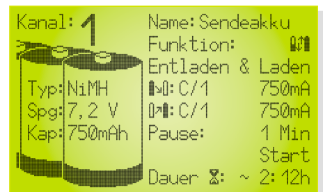
Bild 5: Kanalfenster für Kanal 1, Funktion gestoppt
