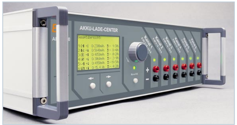
▲ Akku-Lade-Center ALC 9000, Teil 1 Hochwertiges Profi-Akkuladegerät mit 6 Ladekanälen, besonderer Bedienergonomie, Datenlogger-Funktion und USB-PC-Schnittstelle Seite 76
