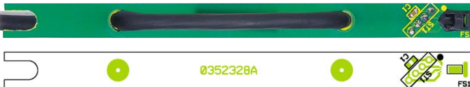
Ansicht der fertig bestückten Sensorplatine mit zugehörigem Bestückungsplan
