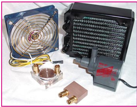
Bild 4: Eine Wasserkühlung arbeitet leise und effizient – sie schafft den CPU-Lüfterkrach ab.
