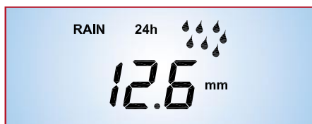
Bild 7: Neben der Regenmengenanzeige erfolgt hier die schnelle Warnung vor beginnendem Regen.
