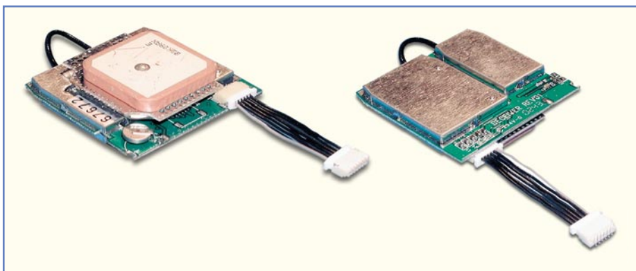
Bild 2: Das gesamte GPS-Modul inklusive Antenne ist nur 41 x 41 x 14 mm groß.
