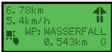
Bild 3: Die Hauptanzeige des GPN 100: oben links die zurückgelegte Wegstrecke, darunter die aktuelle Geschwindigkeit, rechts der Kompasspfeil. Unten der Richtungspfeil zum ausgewählten Wegpunkt sowie die Entfernung dorthin. Rechts unten die Anzeige, dass gültige GPS-Daten empfangen werden.
