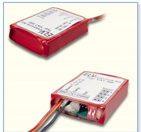
**Bild 12: Fertig eingeschrumpfter Telemetriesender VAT 300 (Ansicht von oben und unten)**
