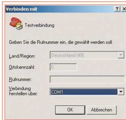
**Bild 1: Einstellungen für das Terminalprogramm zum Testen des Mobiltelefons**
