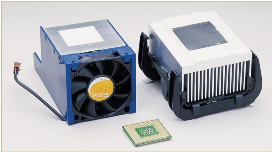
**Bild 5: Der CPU-Kühler, links der Spezialkühler für den MEGA 651, rechts der original Celeron-Kühler**
