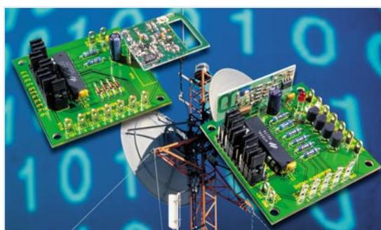
◀ **4-Kanal-HF-Schalt-signalübertragung mit Sicherheitscode**
