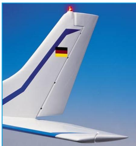
**Bild 2: Seitenleitwerk mit installiertem Anti-Kollisionslicht**
