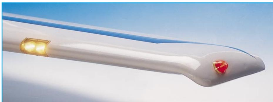
**Bild 3: Tragfläche mit Landeleuchten und Positionslicht**
