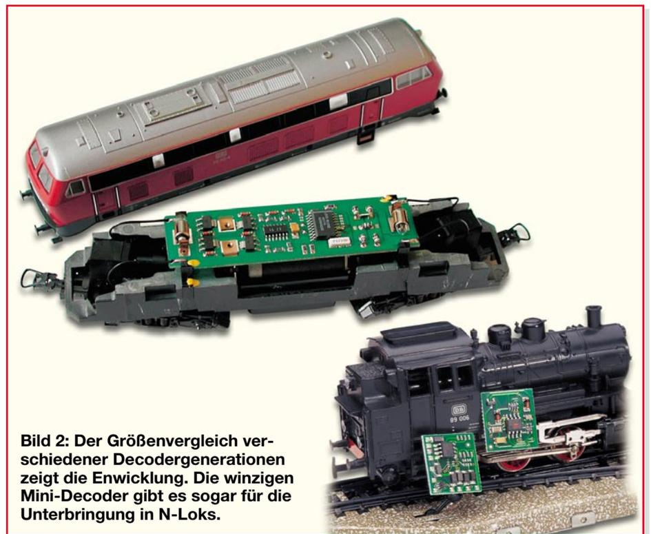
**Bild 2: Der Größenvergleich verschiedener Decodergenerationen zeigt die Entwicklung. Die winzigen Mini-Decoder gibt es sogar für die Unterbringung in N-Loks.**
