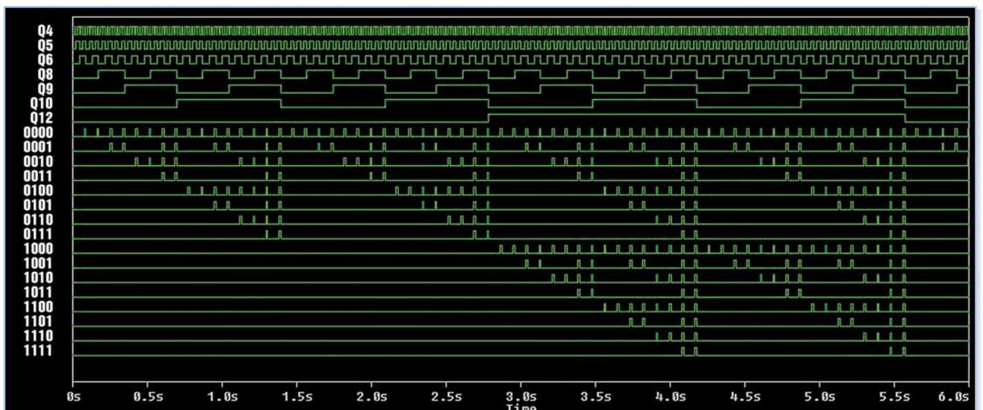
Bild 5: Impulsdiagramm zum LED-Stroboskop
