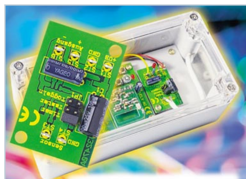
▲ Berührungsloser Taster Kapazitiver Schalter für die berührungslose Auslösung von Schaltvorgängen Seite 43
