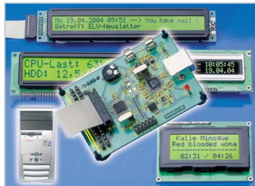
▲ USB-LCD-Ansteuerung Für die Realisierung externer Statusanzeigen am PC, zusätzlich mit 6 Tastereingängen für die Steuerung von Programmen Seite 76
