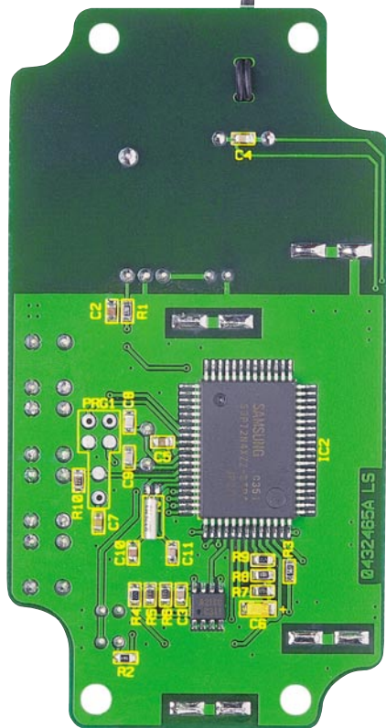
Ansicht der fertig bestückten Platine des FS20 UTS mit zugehörigem Bestückungsplan, oben von der Bestückungsseite, unten von der Lötseite
