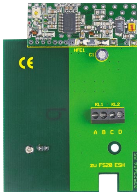
Ansicht der fertig bestückten Platine des FS20 EAM mit zugehörigem Bestückungsplan, oben von der Bestückungsseite, unten von der Lötseite
