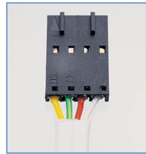
Bild 6a: Die Zuordnung der Adernfarben am Modulstecker
