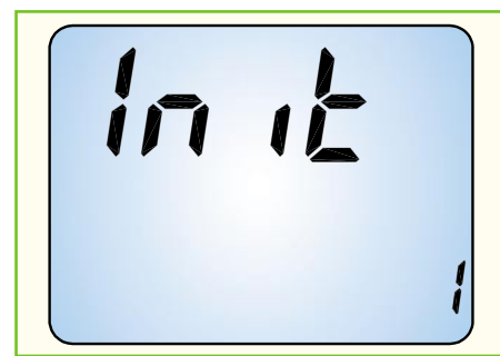
Bild 11: Der Initialisierungsmodus ist gestartet – der Empfänger wartet nun auf Sensor-Sendesignale.
