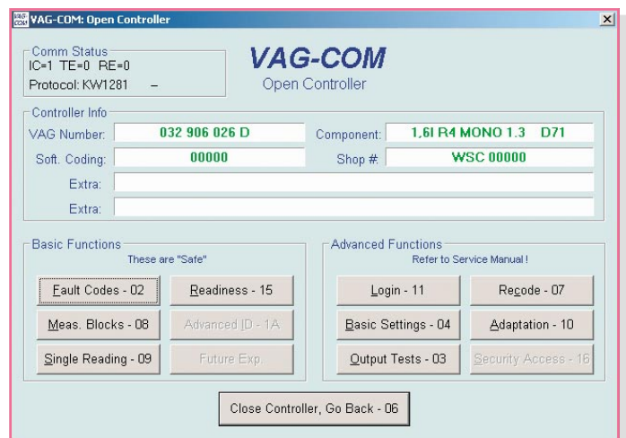
Bild 4: Beispiel für ein Steuergeräte-Auslese-Menü, hier für das Motormanagement
