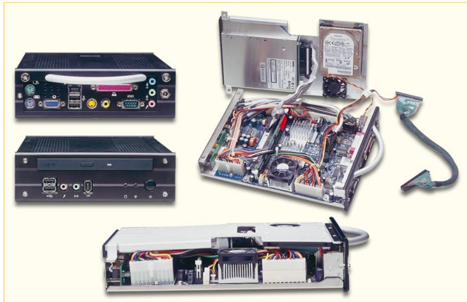
Bild 8: Ein fertig mit Laufwerken bestückter Mini-ITX – man erkennt deutlich die drangvolle Enge im Gehäuse
