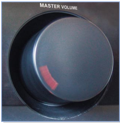
Bild 1: Per Fernsteuerung befehligt, mechanisch gedreht – motorisch angetriebener Lautstärkeinsteller einer hochwertigen HiFi-Anlage. Deutlich ist in der Zeitaufnahme die ausgelöste Drehbewegung am Weg der roten Markierung zu erkennen.
