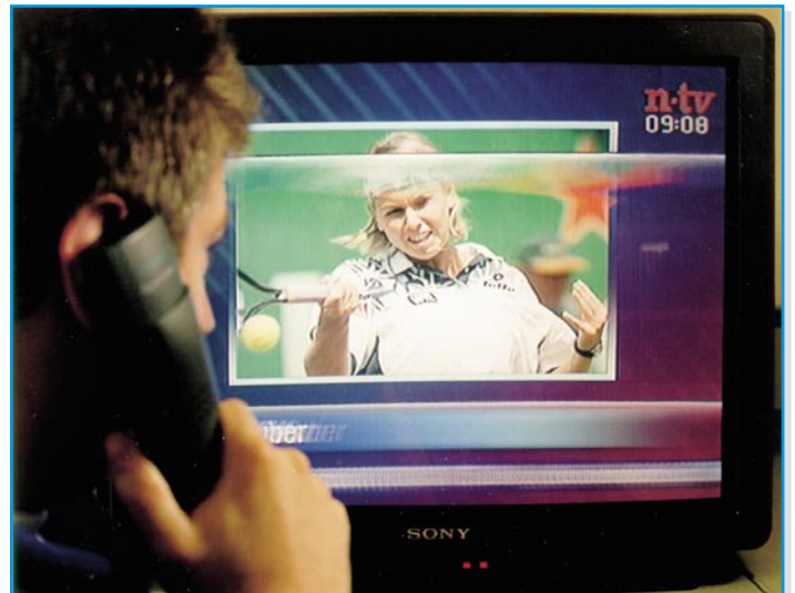
Bild 12: Gleichfrequente Störung von n-tv in der 1. Sat-ZF durch DECT-Schnurlostelefon
