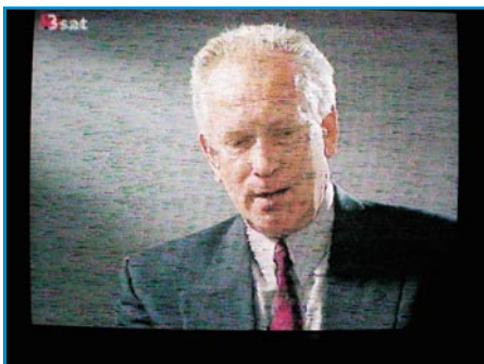
Bild 11: Schwarze Spikes = Receiver zu hoch abgestimmt
