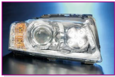
Bild 12: LED-Power im Frontscheinwerfer – Positions-/Tagfahrlicht im Audi A8. Foto: HELLA
