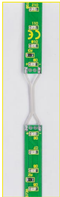
Bild 4: So werden die einzelnen Platinen miteinander verbunden. Wichtig: auf die richtige Polarität achten!
