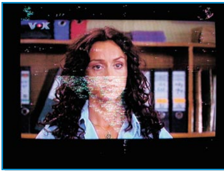
Bild 9: Weiße Spikes = Receiver zu tief abgestimmt
