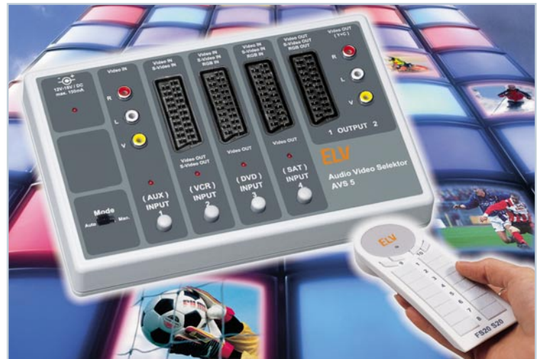
▲ Audio-Video-Selector AVS 5 Der Problemlöser für die heimische Videotechnik – mit automatischer Quellenwahl, RGB- und S-Video-Aufschaltung, Aufnahmeoptionen ... Seite 38
