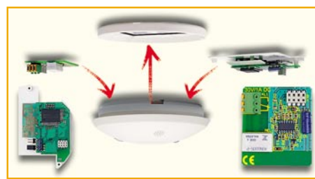
Bild 7: Setzt man von Anfang an auf ein erweiterbares Rauchmeldersystem, hält man sich alle Optionen offen - links ein Funkmodul, rechts ein Relaismodul.
