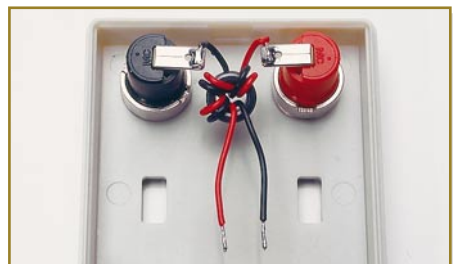
Bild 6: Montage der Ferritspule auf den Zuleitungen zu den Messbuchsen
