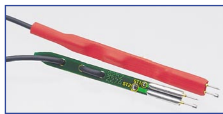
Bild 22: Spezial-Messleitungen mit federnd gelagerten Messspitzen
