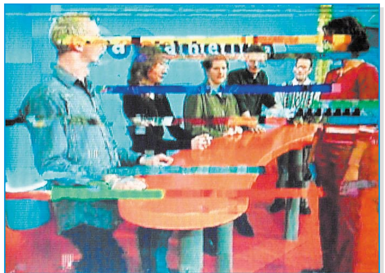
Bild 41: Klötzchenbildung an der (scharfen) Grenze zum Totalausfall der Übertragung
