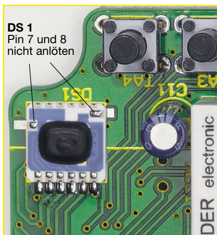
Bild 5: Detailansicht zur Montage des Luftdrucksensors
