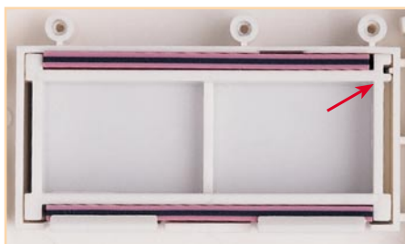
Bild 17: Montage der Leitgummistreifen mit Halterahmen
