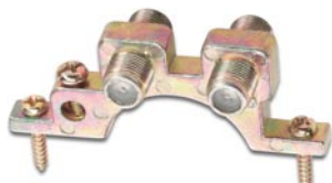
Bild 28: Mit Potentialausgleichsblöcken (hier WISI NB04) werden die Abschirmungen der Koaxial-Kabel auf ein gemeinsames Erdpotential gelegt.
