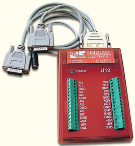
Bild 5: USB-Mini-Messlabor LabJack U12 mit Verteilerkabel für Breakout-Boxen
