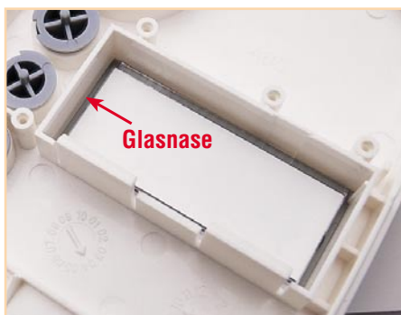
Bild 16: Polaritätsrichtiges Einsetzen des Displays
