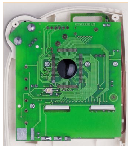
Bild 18: Endmontage der Elektronik in das Gehäuse
