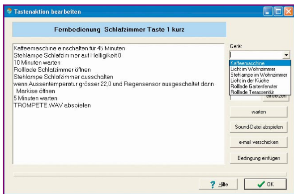
Bild 5: Ein Makro beinhaltet eine Reihe von Anweisungen, die einzelne Geräte des Systems untereinander und mit Aktivitäten des PCs verbinden.
