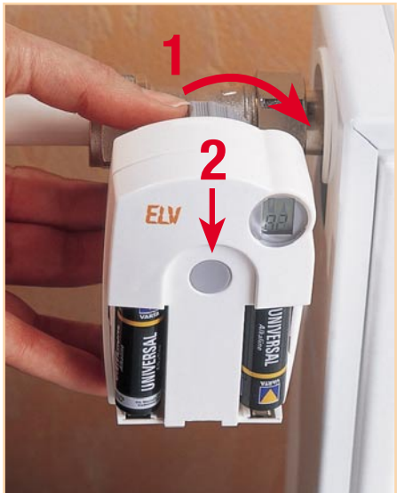
Bild 3: Montage des Funk-Ventilantriebs FHT 80
