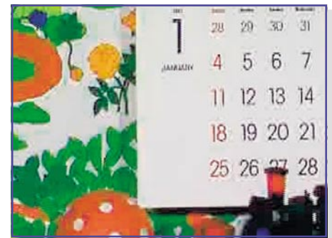
Bild 7: MPEG-typische Bildfehler: Blockbildung (blocking) und Überschwingen an Kontrastgrenzen (ringing). (Quelle: Mitsubishi Electric Research Institute)
