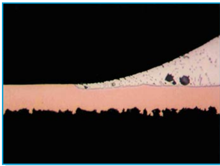
Bild 4: Auflösung von Kupfer an einer Lötstelle, wellengelötet, die Cu-Leiterbahn wird bei jedem Lötprozess dünner.
