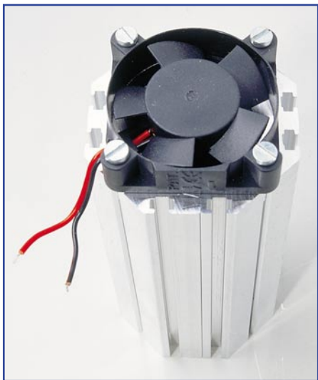
Bild 42: Montage des Lüfters am Kühlkörper
