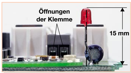
Bild 3: Einbau der LED D 1
