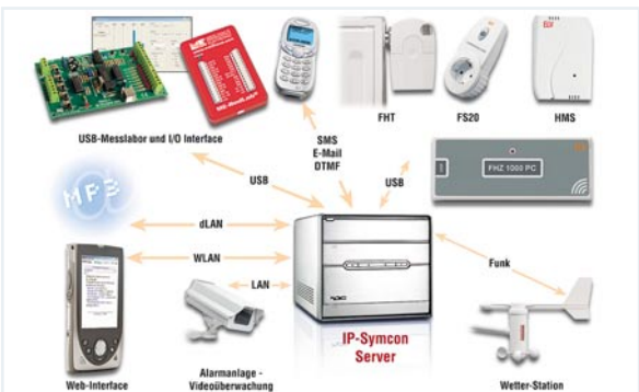
▲ Haussteuerung systemoffen – IP-Symcon und FHZ 1000 PC Die Software IP-Symcon öffnet den ELV-Funk-Haussteuersystemen neue Welten zu Systemen weiterer Hersteller und zu neuen Nutzungsmöglichkeiten Seite 48
