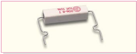
Bild 7: So müssen die Anschlüsse bei den Hochlastwiderständen abgewinkelt werden
