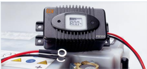
▲ Power Brick PB 500 – Akku-Informationssystem mit Blei-Akku-Aktivator-Funktion Bewahrt den Blei-Akku durch periodische Stromimpulse vor zu frühem Akku-Tod durch Sulfatierung. Mit LCD-Akku-Zustandsanzeige Seite 6
