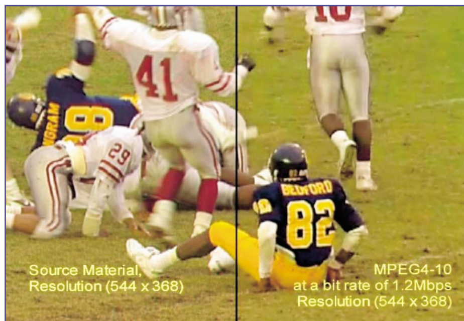
Bild 1: Qualitätsvergleich MPEG-4-2 gegen MPEG-4-10 (Version 2). Ca. 1,5 Stunden Film passen in MPEG-4-Qualität damit auf eine normale Daten-CD. (Quelle: Luke J. Crook, http://www.balooga.com/mpeg4.php3 )
