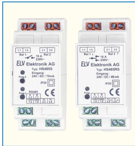
Bild 6: Die fertig montierten Schaltmodule
