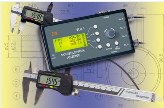
▲ Schieblehrenanzeige SLA 1 Zeigt die Werte von bis zu vier digitalen Schieblehren an und ermöglicht Berechnungen. Mit PS/2-Tastaturport zur Dateneingabe und seriellem Port zur Datenweitergabe Seite 12
