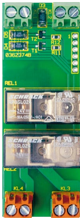
Ansicht der fertig bestückten Grundplatine des HS485 S/RS mit zugehörigem Bestückungsplan
