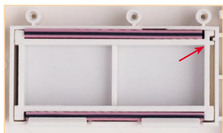
Bild 8: Montage der Leitgummistreifen mit Halterahmen
