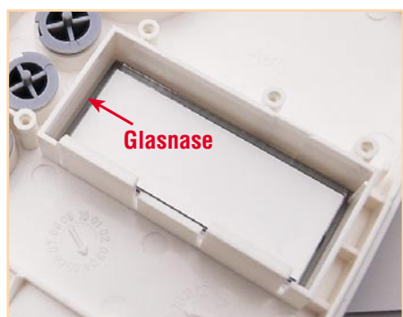
Bild 7: Polaritätsrichtiges Einsetzen des Displays
