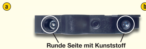
Muttern eingepresst. Die anderen beiden selbstsichernden Muttern werden in die seitlichen Sechskantöffnungen gepresst (Abbildung b) und jeweils von der gegenüberliegenden Seite ist eine Inbusschraube M3 x 14 mm einzuschrauben. Diese Schrauben sind nur mit wenigen Windungen einzuschrauben und noch nicht festzuziehen.
