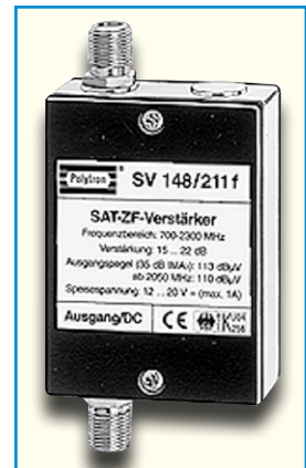
Bild 5: Der Sat-ZF-Verstärker wird in Leitungen mit hoher Dämpfung zwischen Multischalter und Teilnehmer eingefügt. Die Speisung kommt vom Receiver und die Steuersignale werden in Rückwärtsrichtung an den Multischalter weitergeleitet. Quelle Polytron
