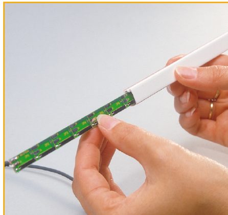
Bild 2: Einführung der Platine in den Mini-Installationskanal
