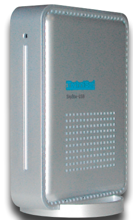
Bild 19: Für den Sat-Empfang via Laptop braucht man eine USB-DVB-S-Box. (Quelle: Technisat)
