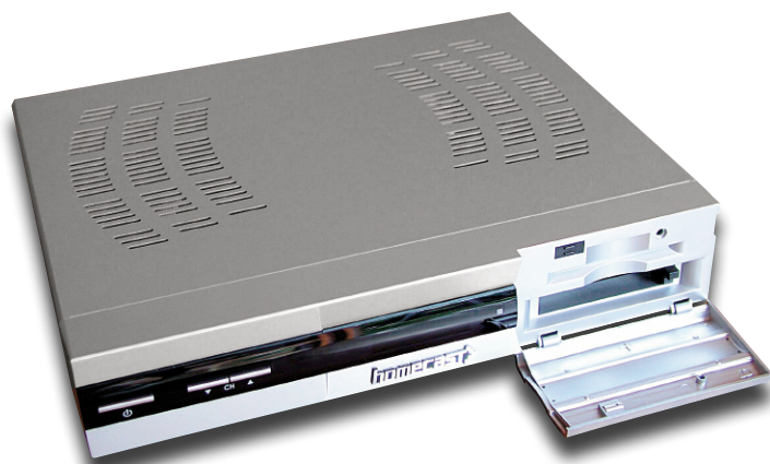
Bild 6: Hinter einer Klappe in der Frontplatte dieses Sat-Receivers sind die Einschubschächte für zwei CA-Module zu sehen.
