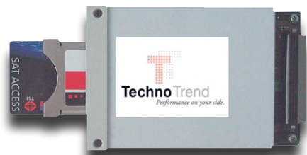
Bild 16: In diesem CI-Modul für die TT PCLine premium kann ein CAM den Zugang zu verschlüsselten Programmen öffnen. (Quelle: TechnoTrend)
