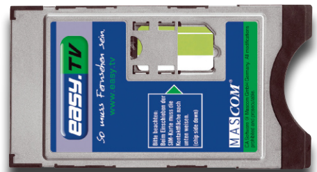
Bild 7: Das Conditional Access Module öffnet die Tür zu den verschlüsselten Programmen. (Quelle: MASCOM)
