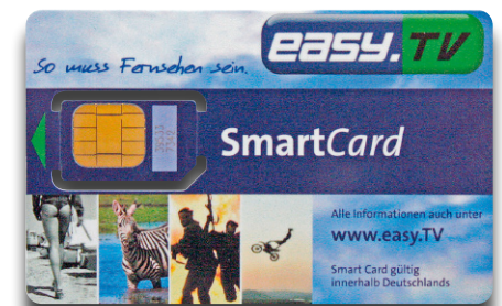
Bild 8: Die Smart Card aktiviert das Conditional Access Module. (Quelle: MASCOM)
