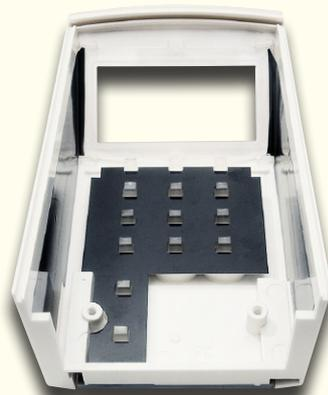
Danach wird die Lichtmaske für die Tasten, wie abgebildet, eingesetzt.
