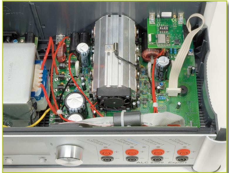
Zur Befestigung des Moduls sind zwei Metallwinkel vorhanden, die zunächst auf der Bestückungsseite positioniert werden. Danach werden sie mit zwei Schrauben M3 x 6 mm und den zugehörigen Fächerscheiben und Muttern an der Platinenunterseite fixiert. Zu beachten ist vor dem Festziehen, dass die Winkel bündig mit dem Platinenrand abschließen.
