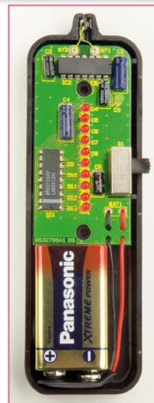
Bild 3: Die Lage aller Komponenten im Gehäuse
