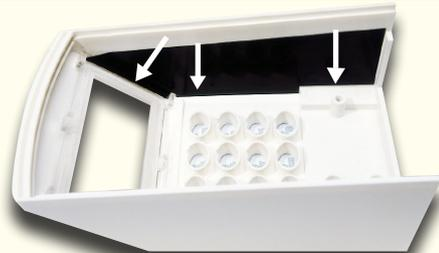
Bei der weißen Gehäusevariante werden die Seitenwände innen mit einer selbstklebenden Lichtmaske abgeklebt. Das Verkleben ist vorsichtig und sehr sorgfältig entsprechend der Abbildung durchzuführen. Zu beachten ist, dass keine Lücken zwischen den Gehäusekanten und den Lichtmasken entstehen dürfen.
