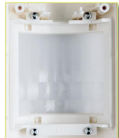
**Bild 7: Hauptlinse und Linsenhalter im eingebauten Zustand**
