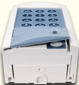
An der Gehäuse-Frontseite sind die beiden Tasterabdeckungen für die Zusatz-tasten einzurasten.
