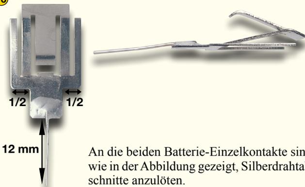
An die beiden Batterie-Einzelkontakte sind, wie in der Abbildung gezeigt, Silberdrahtabschnitte anzulöten.
