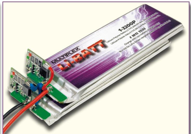
**Bild 5: 2-zelliger Lithium-Polymer-Akku mit nachgerüsteten Balancern**
