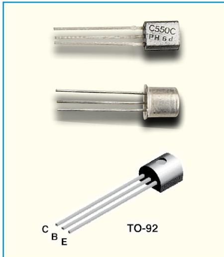
**Bild 4: Typische Bauformen von Kleinsignaltransistoren**
