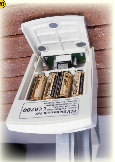
Bei der Endmontage wird zuerst die Montageplatte mit der Anschluss-platine an die vorgesehene Position an der Wand montiert. Bei Bedarf kann an die Schraubklemmen eine externe Spannungsversorgung und/oder eine Klingel angeschlossen werden. Zur Montage des Codeschlusses wird der Stecker des Flachbandkabels auf den dafür vorgesehenen Wannenstecker der Anschlussplatine aufgesteckt, das Codeschloss vorsichtig aufgesetzt und nach unten verrastet.
