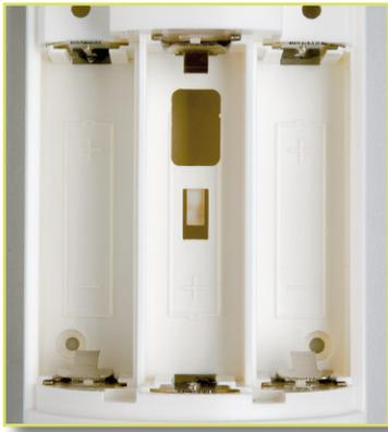
**Bild 8: Batteriefach mit eingesetzten Kontakten**
