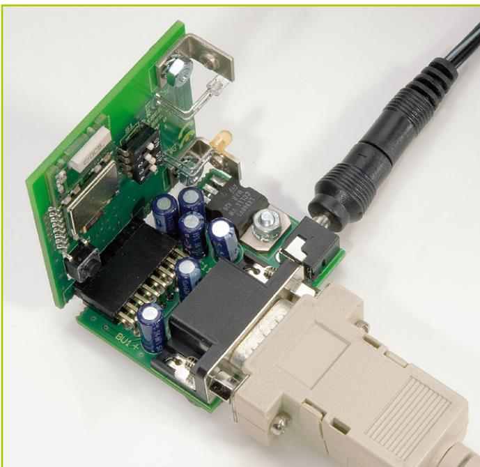
**Bild 2: Anwendung als RS232-Bluetooth-Wandler bzw. Aufbau zum Programmieren des Moduls**
