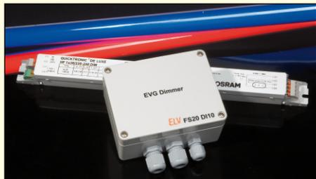
Der Dimmer FS20 DI10 zum direkten Ansteuern von dimmbaren elektronischen Vorschaltgeräten mit einer 1–10-V-Schnittstelle wurde in diesem „ELVjournal“ vorgestellt. Im zweiten Teil stellen wir die Schaltung vor, beschreiben den Nachbau und die Inbetriebnahme der Schaltung.
