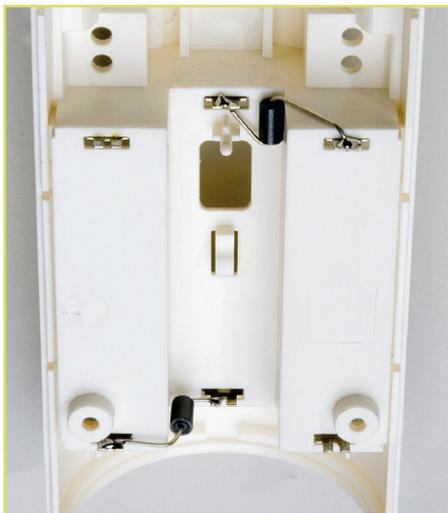
**Bild 9: Verdrahtung der Batteriekontakte mit Dämpfungspettern**
