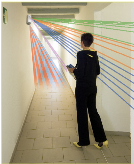
Bild 16: FS20 PIRI-2 im praktischen Einsatz mit den schematisch dargestellten Erfassungsbereichen
