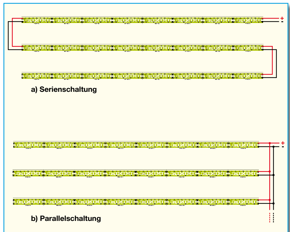
Bild 7: Anschlussplan für die Serien- und Parallelschaltung der LED-Stripes
