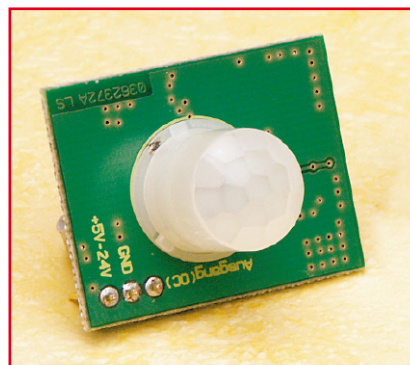
Bild 1: 31 x 25 mm – so kompakt ist der Mini-Bewegungsmelder PIR-13. Er benötigt lediglich eine Einbauöffnung von 13 mm Durchmesser.
