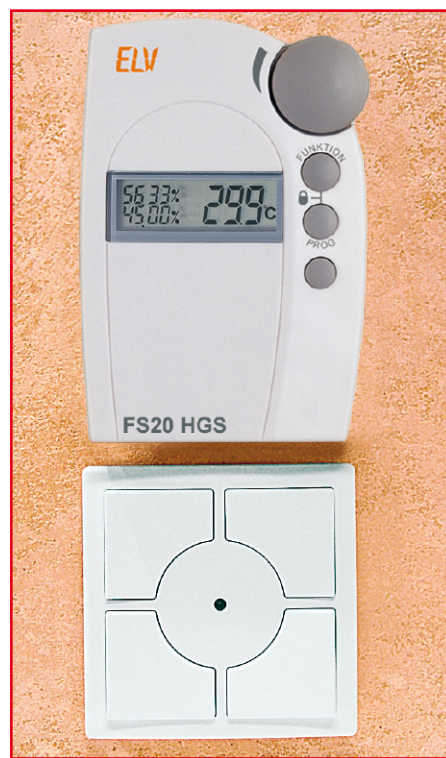
Bild 17: „Bedieneinheit“ für den Deckenlüfter – Wandschalter FS20 S4A und Hygrostat FS20 HGS.
