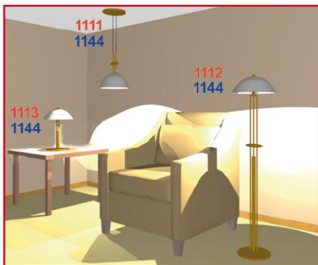
**Bild 1:** Am kleinen Beispiel wird das Codier- und Adress-System schnell „durchsichtig“ – in Rot die Einzeladressen, in Blau die lokale Masteradresse
