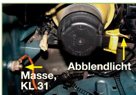
**Bild 5: Für lichttechnische Anwendungen oft benötigt: Abblendlicht-Anschluss sowie der obligatorische Masseanschluss am Chassis.**
