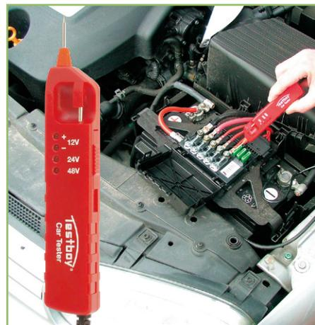
**Bild 2: Für viele Aufgaben genügt bereits ein einfacher und handlicher Spannungstester mit LED-Anzeige.**
