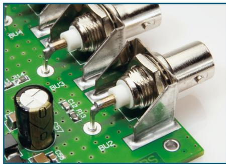
**Bild 9: So erfolgt das Verlöten der BNC-Buchsen.**
