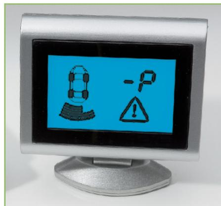
**Bild 1:** Der blau beleuchtete Monitor des Rückfahrwarners zeigt Entfernung und die Lage des Hindernisses an. Hier ist bereits die Kollisionszone unter 30 cm erreicht – anhalten!
