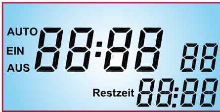
**Bild 1: Alle verfügbaren Segmente des eingesetzten Displays**
