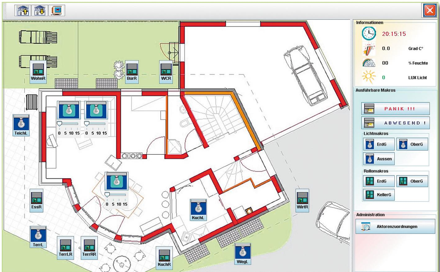
**Bild 5: Die Programmoberfläche der Java-basierten PC-Steuerung mit den Direktbedienungs-Icons, dem Info-Bereich oben rechts und dem Makrosteuerungsbereich**
