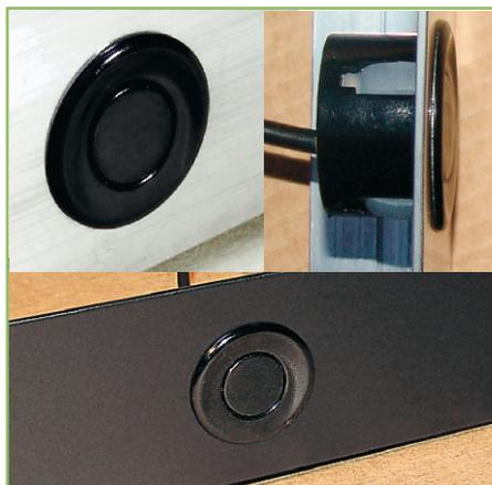
**Bild 4: ... dann Sensor einsetzen, die Beschriftung „UP“ muss oben sitzen. Besonders unauffällig ist der Sensor auf schwarzem Grund.**
