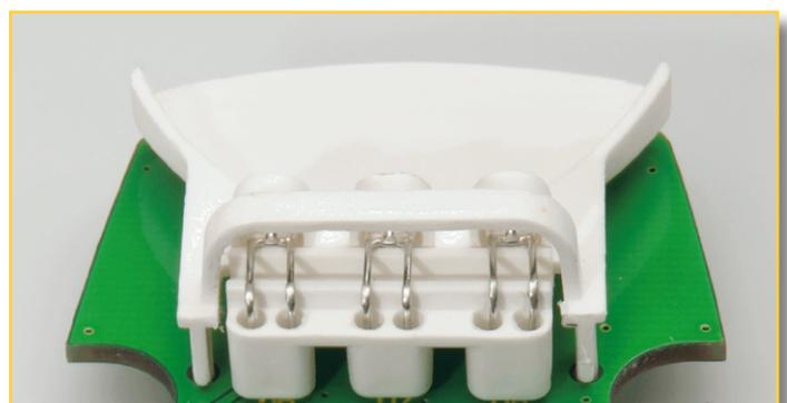
Bild 5: Fertig montierter LED-Reflektor
