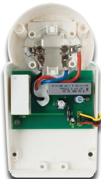
**Bild 5: Die fertig verdrahtete Steckereinheit**
