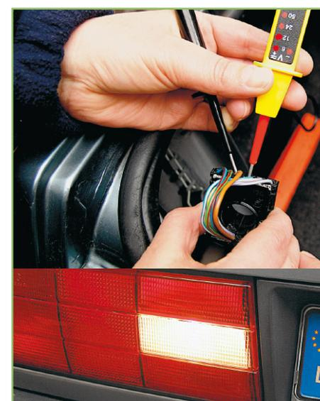
**Bild 6: Mit dem Spannungsprüfer findet man die Leitung für das Rückfahrtsignal sehr schnell – hier sind auch die blau-weiße Standardleitung für das Rückfahrtsignal und die braune Masseleitung gut zu sehen.**
