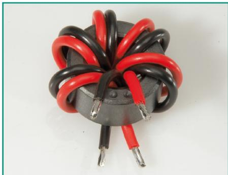
**Bild 59: Durch den Ferritkern gefädelt** Leitungsabschnitte
