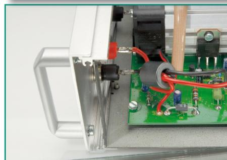
**Bild 72 und 73: Anlöten der Ausgangsleitungen an die Sicherheitsbuchsen**
