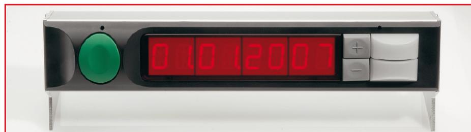
**Bild 1:** Die Uhr im kompakten Aluminiumgehäuse. Hier sind die drei Bedientasten und die beiden LED-Leuchten (rechts) gut zu sehen.
