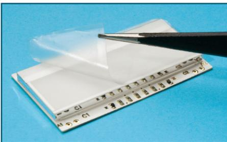
Bild 11: Die Schutzfolie an der Oberseite der Hinterleuchtungsplatine ist abzuziehen.
