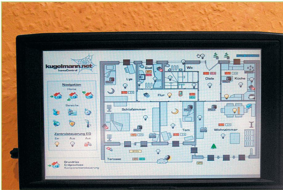
**Bild 8: Die zentrale Bedien- und Kontrolleinheit – ein Touchscreen im Flur mit speziell an den Touchscreen angepasster Symbolik**
