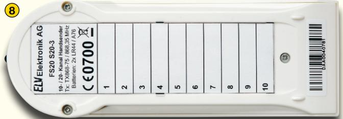
Zum Schluss wird das Typenschild mit Hilfe der Kunststoffabdeckung angebracht.
