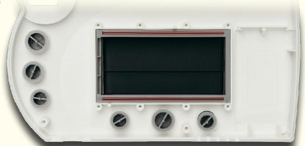
Beim Display ist an beiden Seiten die Schutzfolie zu entfernen, und das Display wird dann, wie in der Abbildung zu sehen ist, auf die Displayscheibe gelegt (die Glasnase des Displays muss nach rechts weisen). Um Fingerabdrücke zu vermeiden, dürfen die Displayflächen bei der Montage nicht berührt werden. Danach wird der Halterahmen für die Leitgummistreifen wie abgebildet eingesetzt und mit den beiden Leitgummistreifen bestückt.
