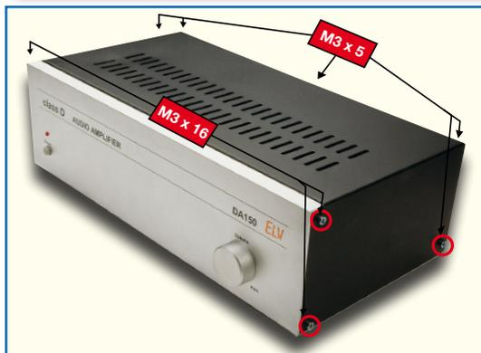
Im letzten Arbeitsschritt ist das Gehäuseoberteil im hinteren Bereich mit 5 Inbusschrauben M3 x 5 mm und im Bereich des Frontprofils mit 4 Inbusschrauben M3 x 16 mm zu verschrauben (Abbildung 16). Der praktische Aufbau des DA 150 ist damit vollständig abgeschlossen und dem Einsatz steht nun nichts mehr entgegen. **ELV**
