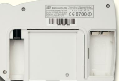
Das Gehäuseunterteil ist mit 4 Schrauben 2 x 8 mm fest zu verschrauben.
