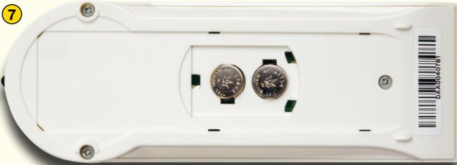
Der Gehäuseboden kann nun aufgesetzt und verschraubt werden. Beim Einsetzen der Batterien ist darauf zu achten, dass sich der Pluspol (+) oben befindet. Anschließend wird der Batteriedeckel eingesetzt.
