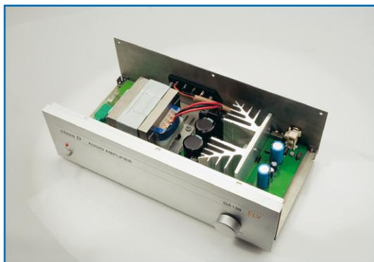
Bild 15: Innenansicht des fertig aufgebauten Class-D-Verstärkers
