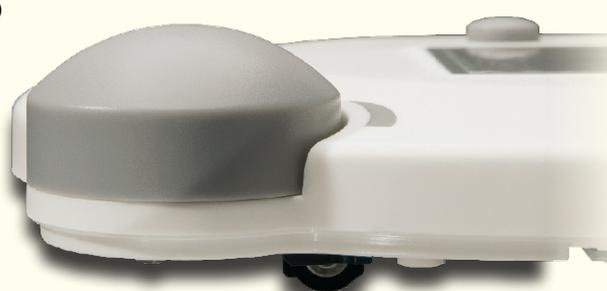
Im nächsten Arbeitsschritt wird der Drehknopf des Drehimpulsgebers stramm auf die zugehörige Achse gepresst.
