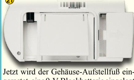
Jetzt wird der Gehäuse-Aufstellfuß eingerastet, eine 9-V-Blockbatterie eingelegt und das Batteriefach mit dem zugehörigen Deckel verschlossen.
