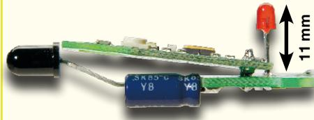
Der Elektrolyt-Kondensator C 7 und die Fotodiode D 7 werden liegend bestückt und verlötet. Dabei ist auf die richtige Polarität der Bauteile zu achten (der Minus-Anschluss des Elkos ist in der Regel gekennzeichnet; die abgeflachte Gehäusesseite und der kürzere Anschluss markieren die Katode der Diode). Die Fotodiode wird vorher so abgewinkelt, dass sie nachher in die Gehäuseöffnung passt. Die LED wird mit einer Einbauhöhe von 11 mm, unter Beachtung der korrekten Polarität, verlötet.
