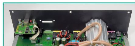
**Bild 75: Montierte Rückwand am Gehäuseunterteil mit USB-Modul**
