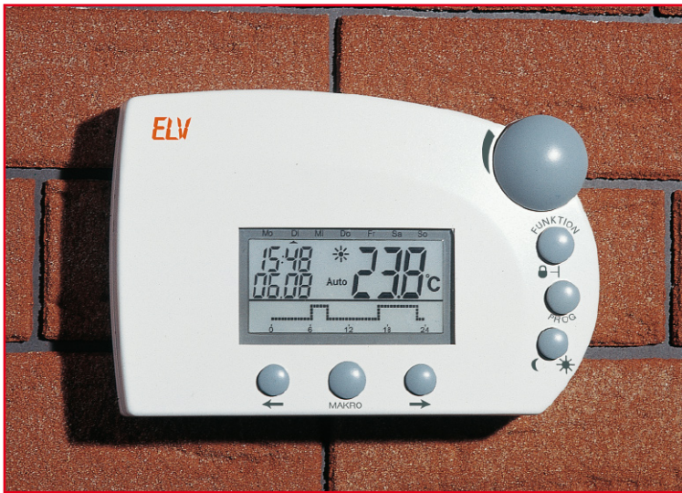
Bild 11: Kann noch mehr, als nur Rollläden steuern – die FHZ 1000 regelt die Heizung, meldet Gefahren und ist in der Lage, bereits komplexe Steuerszenarien über Makros auszuführen.
