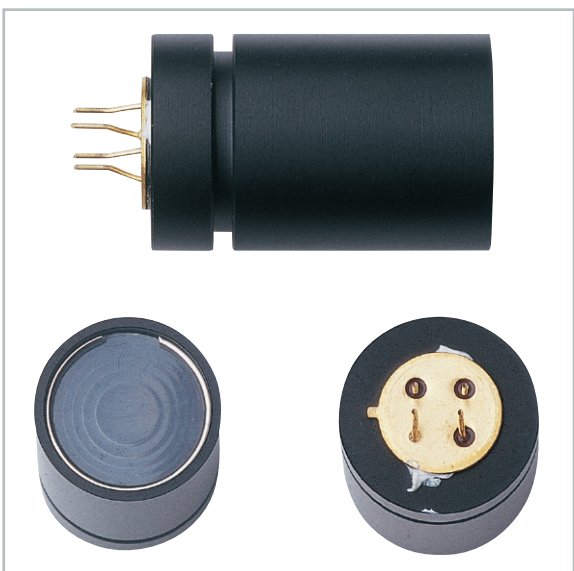
Bild 7: Ansicht der fertig montierten Linse
