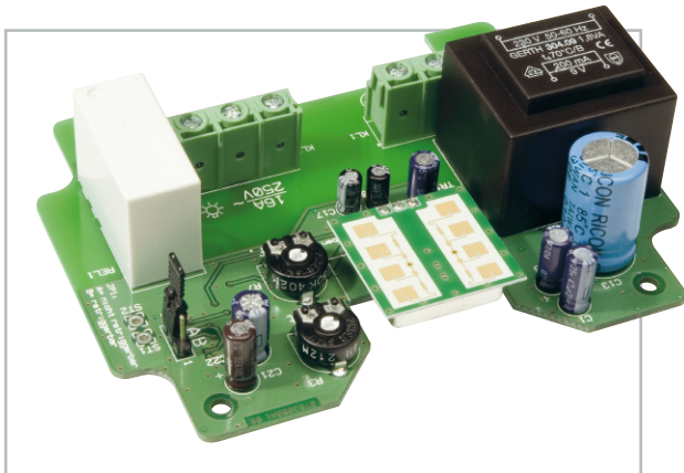
Bild 4: Montage des Sensors zur Erfassung durch den Gehäusedeckel
