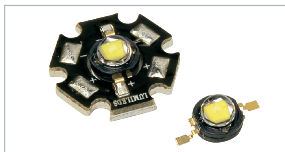
Bild 1: Die beiden verbreitetsten Bauformen der Luxeon-Power-LEDs. Während die Hexagon-Form die notwendigen Kühlflächen bereits enthält, sind für die so genannte Emitter-Bauform entsprechende Kühlflächen erforderlich.
