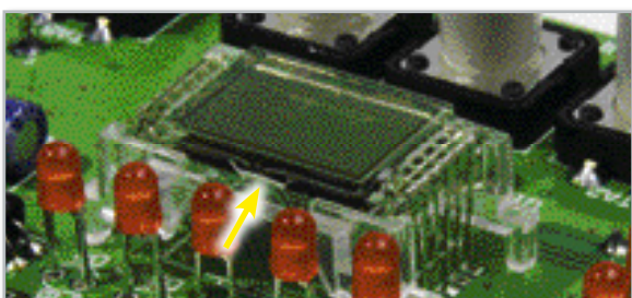
Bild 10: Die Polarität des Displays ist an der kleinen Glasnase zu erkennen.
