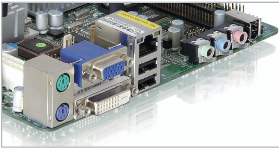
Bild 10: Im Mini-ITX-Format finden sich noch (fast) alle Schnittstellen wie gewohnt auf der Rückseite versammelt.
