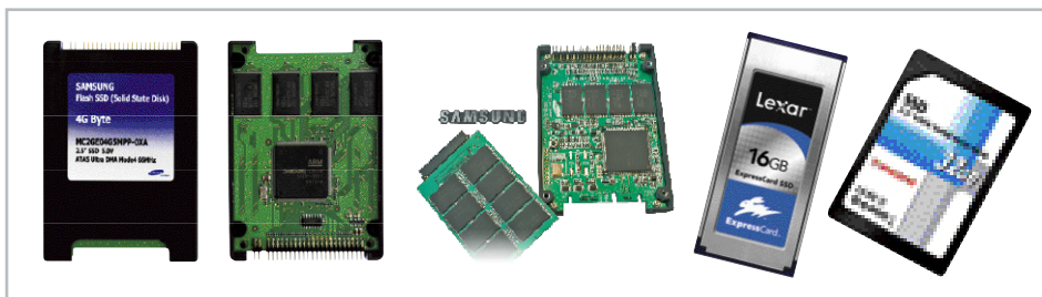
Bild 14: Solid State Discs haben eine große Zukunft als Ersatz für die Festplatte vor sich. In tragbaren und lautlosen Systemen werden sie bald Standard sein. (Bilder: 2 x Samsung, Lexar, Transcend)
