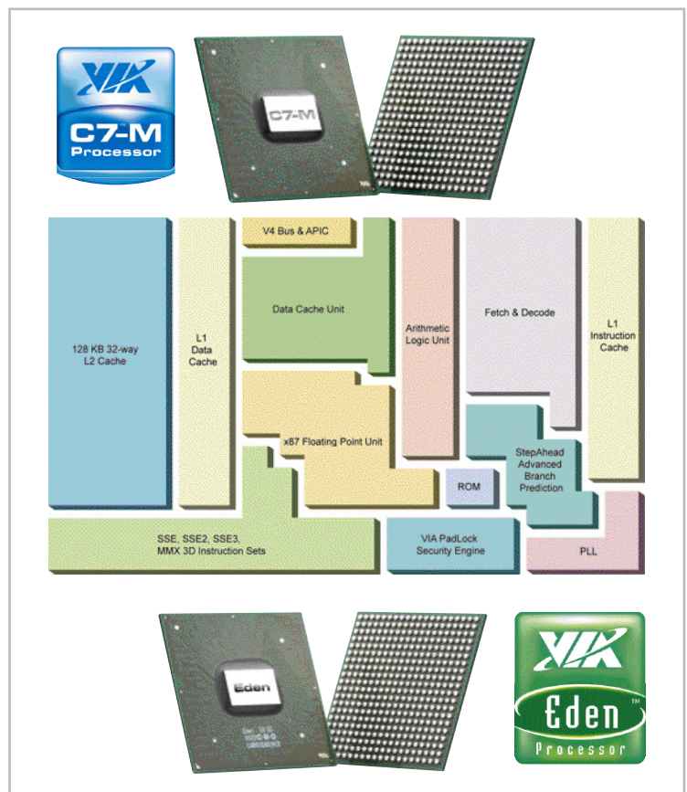
Bild 22: Die Stromspar-Generation von VIA – oben die Architektur des C7 M, unten der 1-W-EDEN-Prozessor 500 MHz. (Bilder: VIA Technologies)
