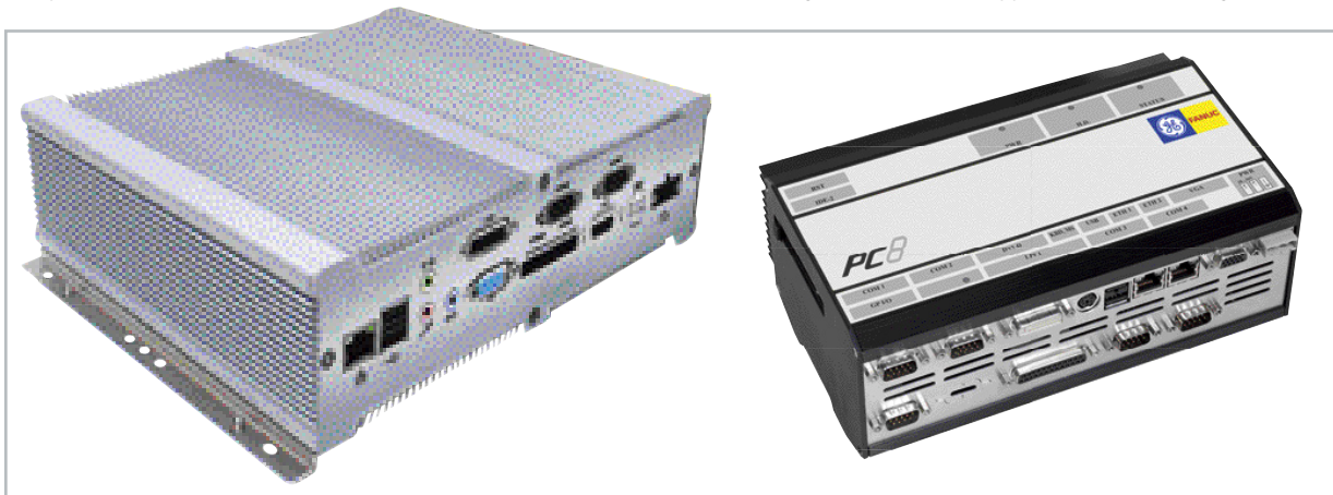
Bild 3: Die andere Form des Mini-Industrie-Rechners – sieht dem Consumer-Mini-PC schon ähnlicher. (Bilder: GE Fanuc/Spectra)
