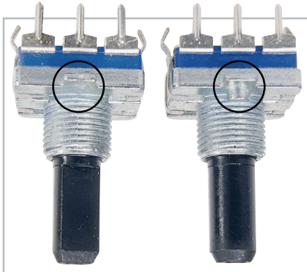
Bild 14: Die Führungsnase des Inkrementalgebers (rechts) wird abgeschnitten (links).
