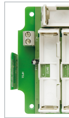
Bild 3: Seitlich angelötetes HF-Sendemodul
