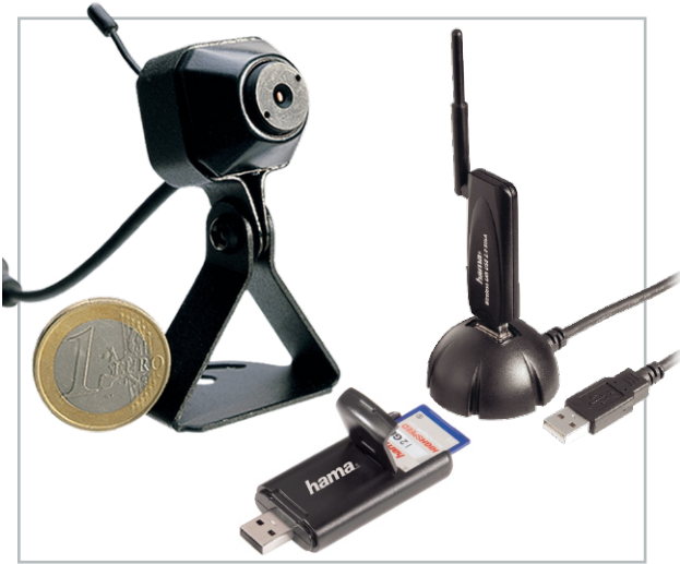
Bild 1: 2,4-GHz-Sendesysteme sind extrem kompakt realisierbar und somit auch gut unauffällig zu installieren. Links ein komplettes Mini-Kamera-Sendersystem, rechts ein Mini-WLAN-Sender, in der Mitte ein Bluetooth-Stick, der sogar noch einen Speicherkartenleser enthält. Besonders Geräten wie letzterem Bluetooth-Stick sieht man seine Hauptfunktion zunächst nicht an.
