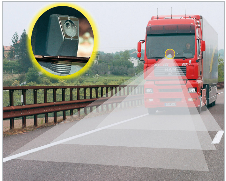
Bild 2: Die Kamera hinter der Frontscheibe tastet ständig die Fahrbahnmarkierungen ab. Die Auswertung erfolgt durch intelligente Bilderkennung (Pixelauswertung). (Bild: MAN)
