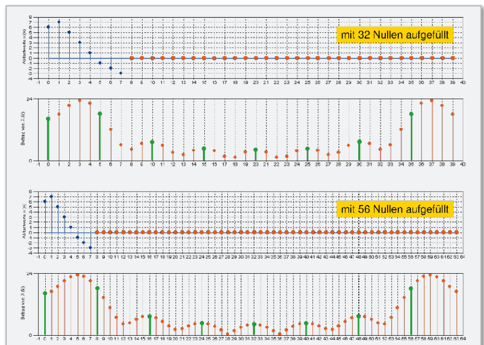
Bild 55: Zero Padding im Zeitbereich mit 8 Signalwerten und 32 bzw. 56 Nullwerten.
