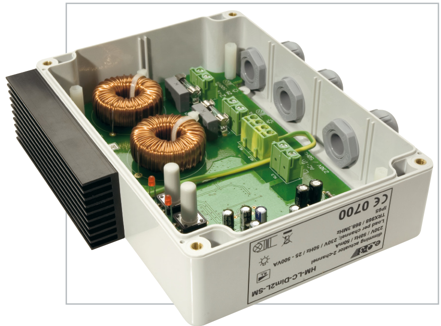
Bild 5: Das fertig montierte Gerät, hier noch ohne Bedienplatte und Gehäusedeckel
