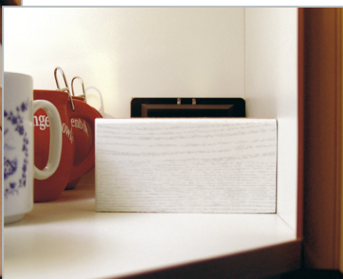
Bild 4: Der verdeckt eingebaute Marinelautsprecher im Eckschrank. Hier sieht man noch den bisher installierten Lautstärkeregler des Verstärkers. Innen schützt ein kleines Board den Lautsprecher vor dem „Nutzinhalt“ des Schrankes. Im Hintergrund ist die Hochton-Frequenzzweiche zu sehen.
