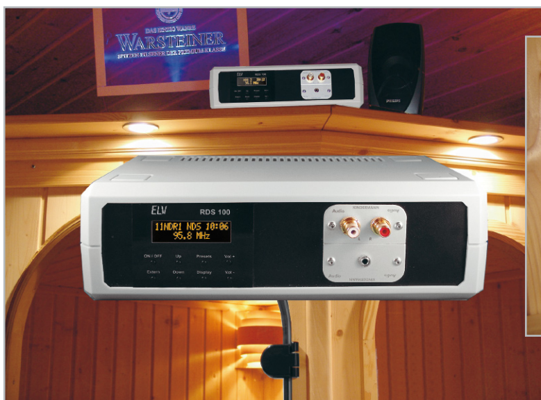
Bild 15: Das „Sauna-/Party“-Radio in Aktion. Die Lautstärkesteuerung aus der Sauna heraus erfolgt über einen kleinen Kipptaster am Lautsprecher, der einen FS20-Batteriesender in der Wand ansteuert.
