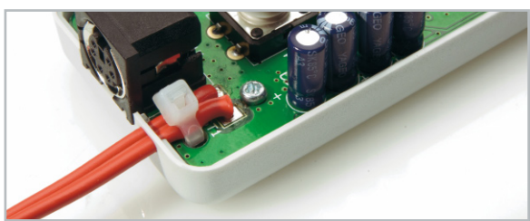
Bild 3: Anbringen der Anschlussleitung inkl. Zugentlastung
