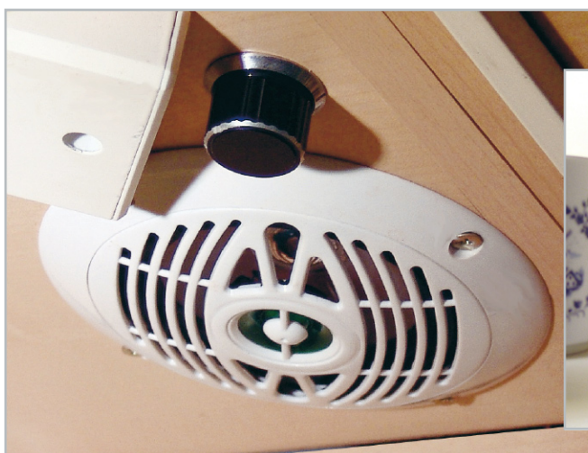
Bild 4: Der verdeckt eingebaute Marinelautsprecher im Eckschrank. Hier sieht man noch den bisher installierten Lautstärkeregler des Verstärkers. Innen schützt ein kleines Board den Lautsprecher vor dem „Nutzinhalt“ des Schrankes. Im Hintergrund ist die Hochton-Frequenzzweiche zu sehen.
