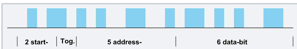
Bild 5: Aufbau des RC5-Fernbedienungsprotokolls
