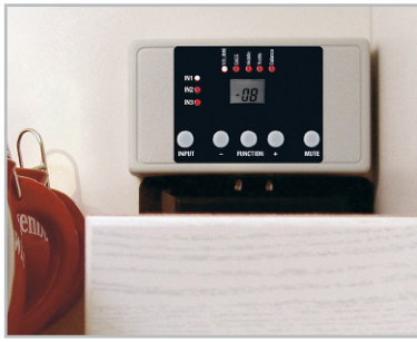
Bild 16: Hier ist das Bedienteil des FS20 DAP3 gut untergebracht. Ein Klettband hält es fest, so kann es bei Bedarf einfach abgenommen werden.
