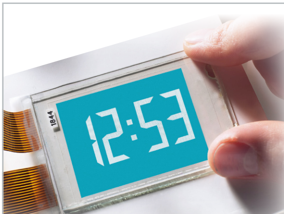
Bild 11: Ein einfaches, starres monochromes EWD zum Anzeigen der Uhrzeit (Quelle: LiquaVista)
