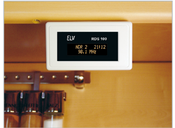
Bild 6: So findet das RDS-Modul in einem kleinen Klappgehäuse unter bzw. hinter der Schrankblende seinen Platz.
