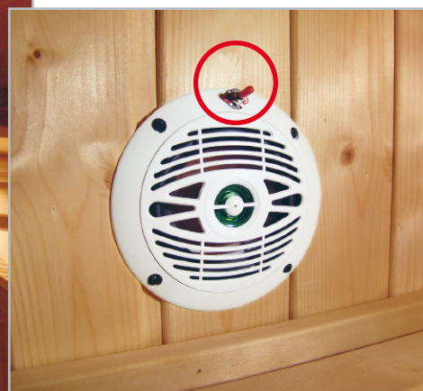
Bild 15: Das „Sauna-/Party“-Radio in Aktion. Die Lautstärkesteuerung aus der Sauna heraus erfolgt über einen kleinen Kipptaster am Lautsprecher, der einen FS20-Batteriesender in der Wand ansteuert.
