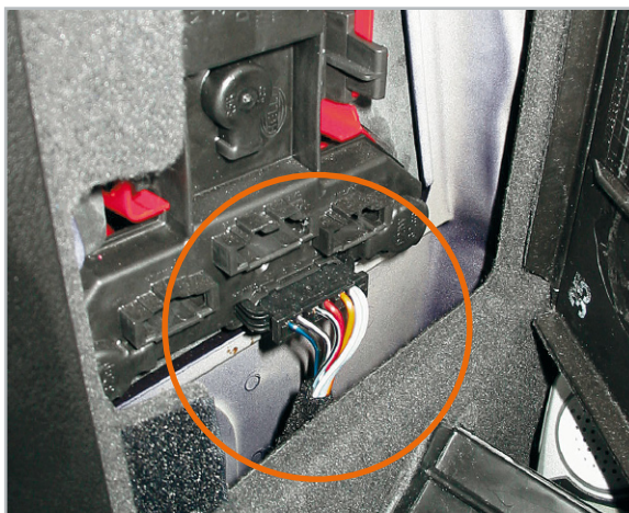
Bild 1: So findet man die Leitungen, die an die Rückleuchte gehen. Rückleuchte und Stecker befinden sich meist hinter Abdeckungen.
