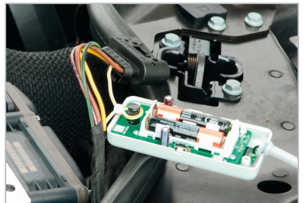
Bild 6: Hier ist die Leitung um den Sensor gelegt.
