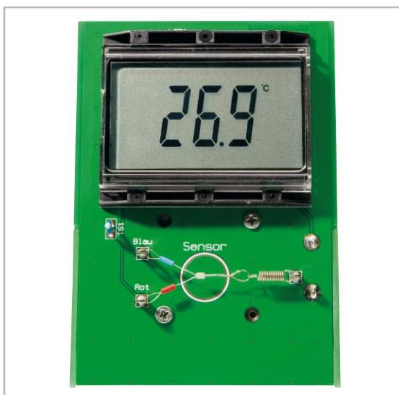
Bild 5: So wird der Sensor zusammen mit der Zugfeder in die Lötstifte eingehängt.
