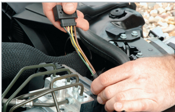
Bild 4: Um die benötigte Leitung aus dem Kabelbaum herauszulösen, ist dessen Mantel auf ca. 10 cm zu entfernen bzw. zurückzustreifen.
