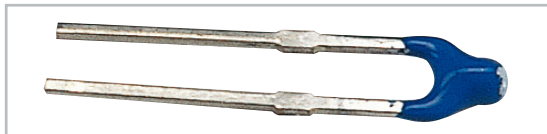
Bild 4: Der eingesetzte Temperatursensor. Deutlich erkennt man die Verdickungen in den Anschlüssen. Bis hierher ist der Sensor in die Platine einzusetzen.
