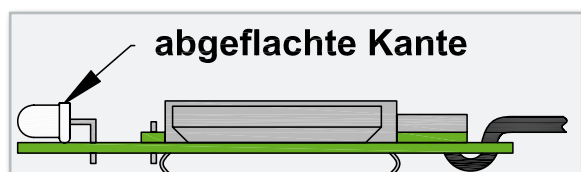
Bild 4: Einbaulage der DUO-LED in der Funk-Schalterschnittstelle HM-Swl-3-FM. Wichtig: Die LED muss mit der Platinenkante abschließen, damit eine problemlose Gehäusemontage erfolgen kann.
