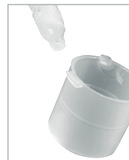
Bild 6: So wird ganz wenig Kleber auf die Haltenasen der Abdeckkappe aufgetragen.
