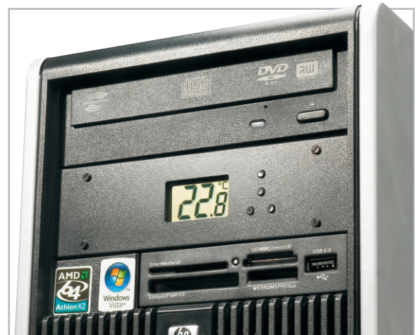
Bild 8: Die Integration der PLS 100 in eine freie PC-Laufwerksabdeckung
