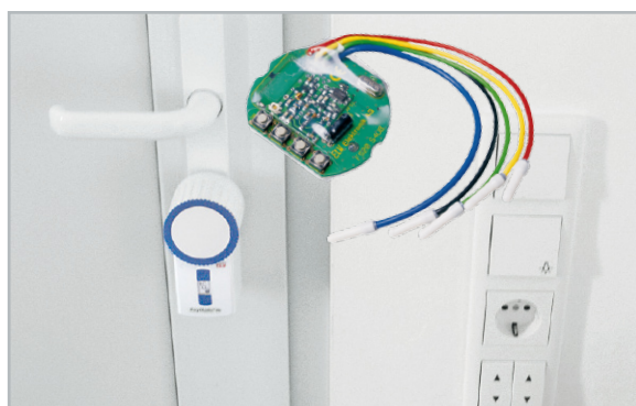
Bild 3: Rechts die dank Unterputz-Batteriesender sauber in die Installationsserie eingepassten Tasten für die Öffnung der Garagentore, links der KeyMatic-Türschlossantrieb
