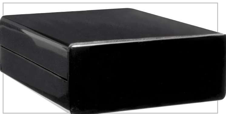
Bild 7: Das fertig montierte Gerät von vorn. Das dunkel eingefärbte Gehäuse stellt für IR-Strahlung kein Hindernis dar.
