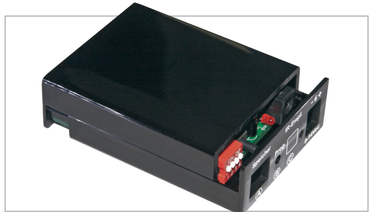
Bild 6: Beim Zuschieben des Gehäuses ist darauf zu achten, dass der rote DIP-Schalter genau in die Aussparung passt und nicht nach hinten gebogen wird.
