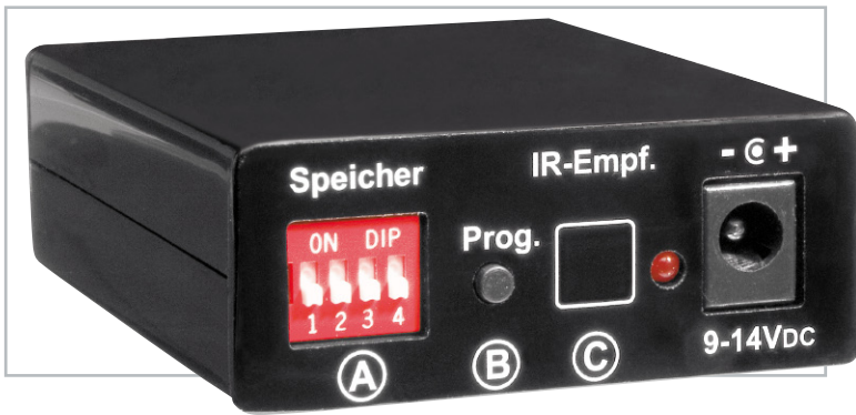
Bild 2: Ansicht der Geräterückseite mit Bedienelementen und A-, B-, C-Kennzeichnung für die Bedienreihenfolge
