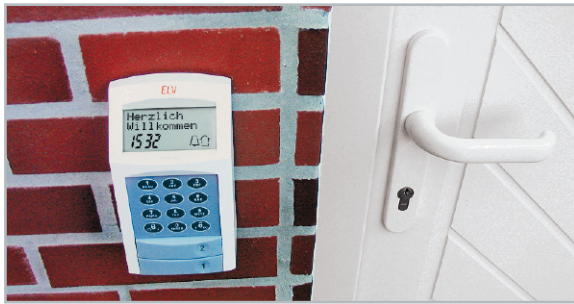
Bild 5: Über die Funktionstasten des KeyMatic-Codeschlosses können die Garagen verschlossen und geöffnet sowie Keller- und Haustür auf einen Knopfdruck verschlossen werden.
