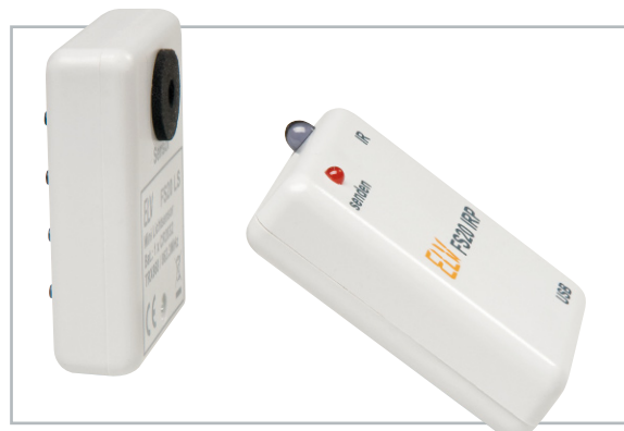
Bild 2: Der FS20 LS ist durch das Infrarot-Programmier-Tool FS20 IRP besonders komfortabel programmierbar.
