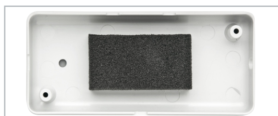
Bild 17: Die richtige Position des Schaumstoffstücks im Gehäusedeckel
