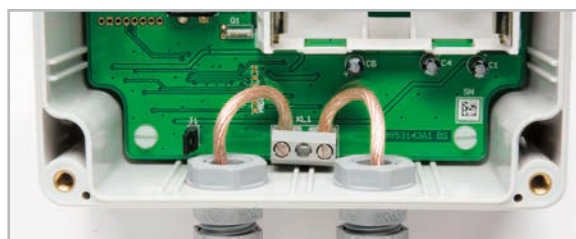
Bild 7: Die Montage und der Anschluss der Messleitung im Gehäuse der Mess-Station
