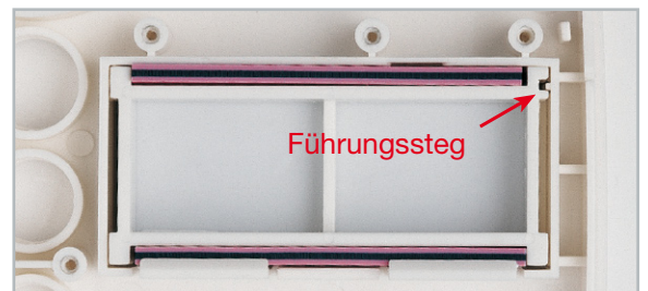
Bild 8: Montage des Halterrahmens und der Leitgummistreifen
