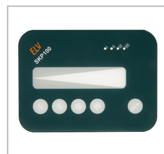
Bild 4: Die universell einsetzbare Frontplatte des SKP 100. Für eine individuelle Gestaltung gibt es eine unbedruckte, transparente Frontplatte dazu.
