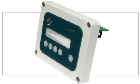
Bild 8: Einsatzvariante für den robusten Außenbetrieb – das SKP 100 ist in einem wasserdichten IP-65-Gehäuse untergebracht. Die Befestigung im Gehäuse erfolgt durch die aufgeklebte Frontplatte.
