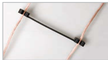
Bild 6: So werden die Abstandshalter an der Messleitung angebracht
