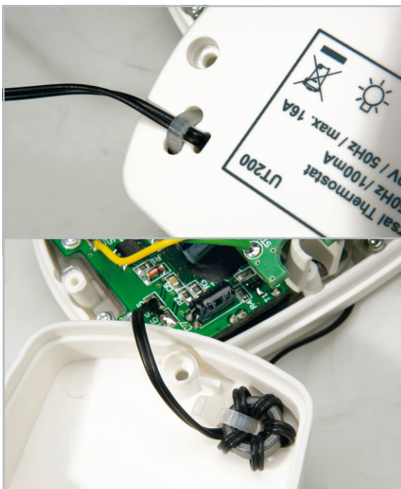
Bild 5: So wird das Sensorkabel um den Ferritring gelegt und mit einem Kabelbinder gesichert. Der Verschluss muss neben dem Ferritring eingelegt werden (siehe Bild unten), damit der Zusammenbau des Gehäuses problemlos erfolgen kann.
