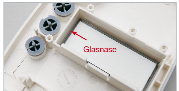
Bild 7: Polarisrichtiges Einsetzen des Displays
