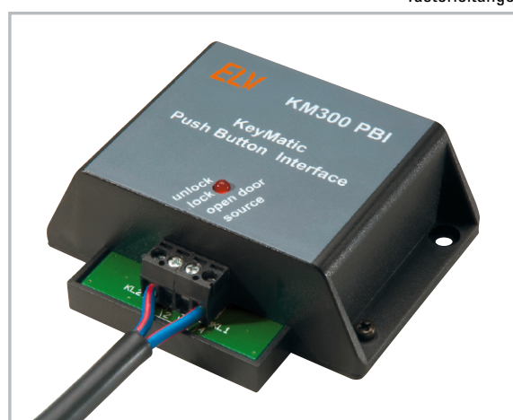
Bild 6: Der Anschluss der Tasterleitungen
