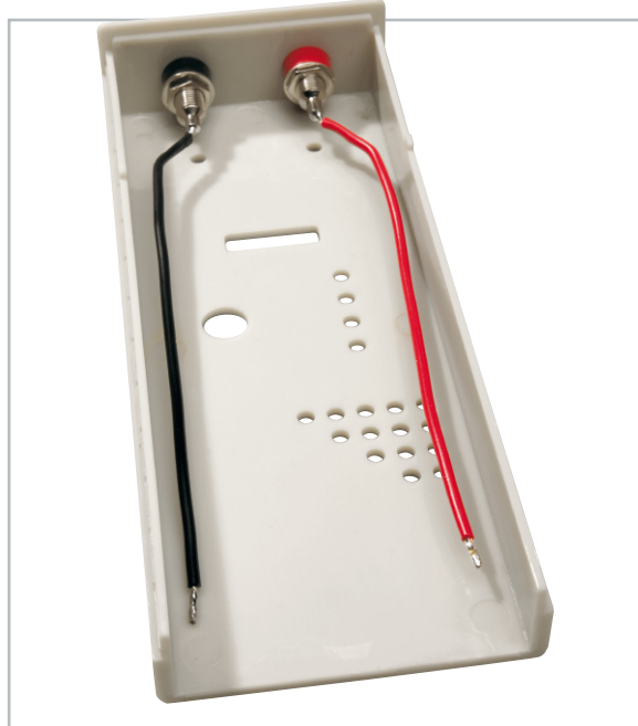
Bild 7: Einbau der Ladebuchsen und Verlegung der Anschlussleitungen im Gehäuse
