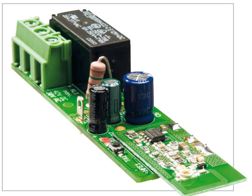
Bild 4: Komplette Empfangseinheit mit Schaltrelais
