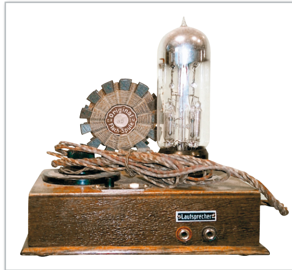
Bild 3: Der Detektorempfänger (hier mit nachgeschalteter Verstärkerröhre) markierte den Beginn des Rundfunkzeitalters. (Quelle: Wikimedia)
