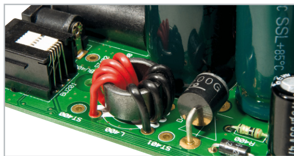
Bild 22: Auf die Leiterplatte montierte Entstördrossel L 400
