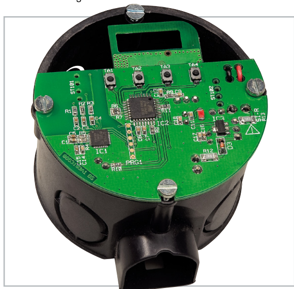
Bild 2: Montage der Basiseinheit auf eine Unterputzdose
