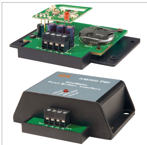
Bild 3: So erfolgt die Montage der komplett bestückten Platine in das Gehäuse.
