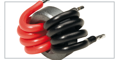
Bild 21: Ansicht der durch den Ferritkern gefädelteten Leitungsabschnitte von der Seite
