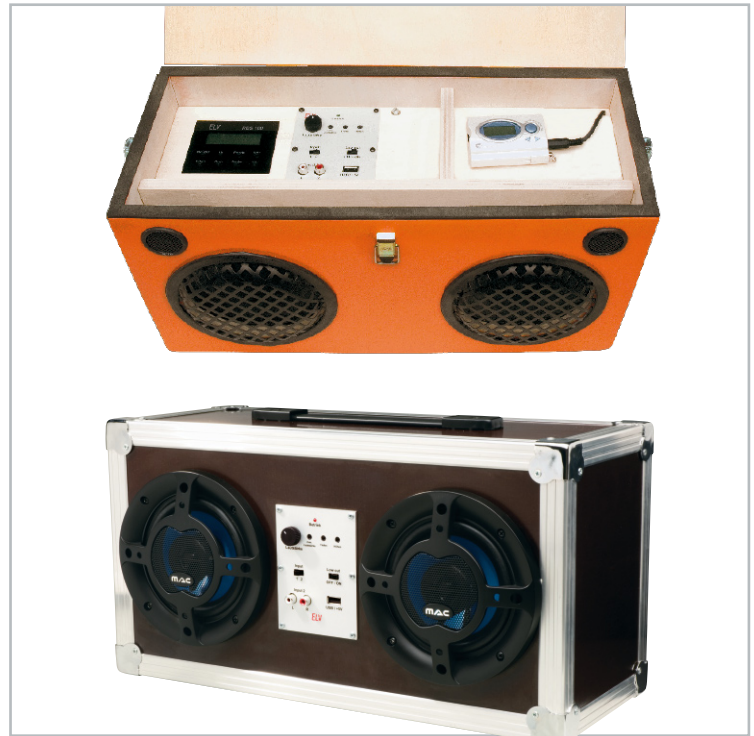
Bild 1: Die beiden Gehäuseversionen der Musikbox, oben mit Klappdeckel und innenliegendem Gerätefach, unten die geschlossene Version
