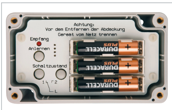
Bild 6: Das fertig montierte Gerät mit eingesetzten Batterien. Jetzt ist nach dem Anlernen nur noch der Gehäusedeckel aufzusetzen und zu verschrauben.
