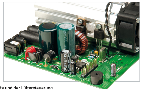
Bild 16 und 17: Am Kühlkörper montierte Bauelemente der Lade-/Entladeendstufe und der Lüftersteuerung
