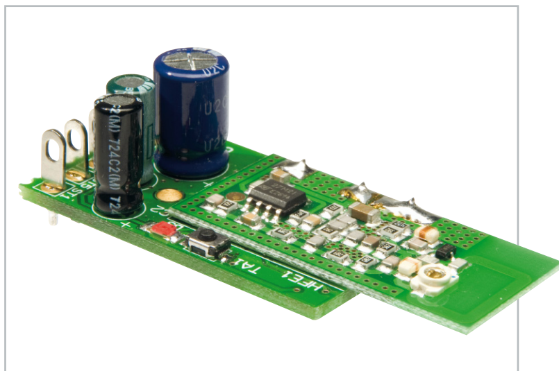
Bild 3: In der Open-Collector-Variante zeichnet sich das Modul durch besonders geringe Abmessungen aus.
