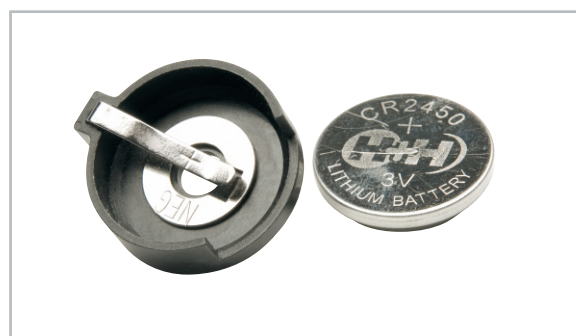
Bild 2: Der Batteriehalter mit der Knopfzelle. Diese ist so einzusetzen, dass der Pluspol nach außen zeigt, also zur mit dem Pluszeichen markierten Haltefeder. Beim Einsetzen und Herausnehmen kein metallisches bzw. stromleitendes Werkzeug einsetzen.
