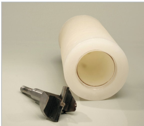
Bild 5: Eine normale Kerze, mit einem Forstner-Bohrer ausgedreht und einem schlanken Glas stabilisiert, nimmt die Schaltung samt Batterie auf.
