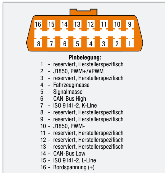
Bild 2: Die Belegung der OBD-II-Buchse im Fahrzeug. Die reservierten Pins können vom jeweiligen Hersteller individuell belegt werden.
