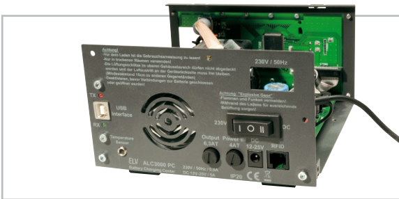
Bild 31: Montage der Gehäuserückwand am Gehäuseunterteil
