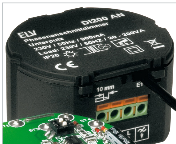
Bild 9: Der Sensorkontakt ist, wie hier gezeigt, aus dem Gehäuse herauszuführen.
