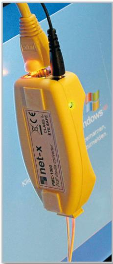
**Bild 23:** Mit zwei Medienwandlern optisch/elektrisch an Anfang und Ende einer Duplex-POF-Strecke hat man voll transparent ein Ethernet-Kabelsegment nachgebildet. (Medienwandler: Technetix)
