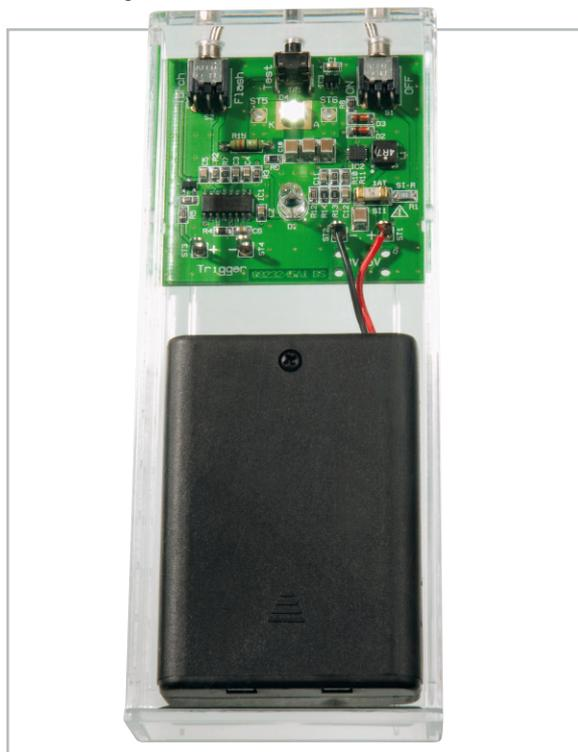
Bild 6: Platine mit Batteriehalter, im Gehäuse eingebaut
