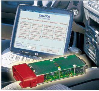
**Bild 9:** Besonders preiswert: Bausätze für ein bestimmtes Protokoll, hier der ELV-Diagnose-Adapter für VAG-Fahrzeuge
