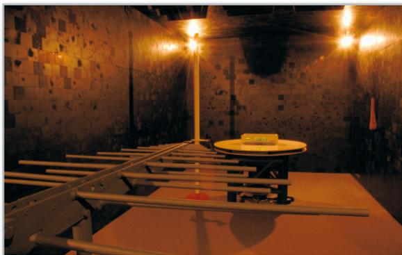
**Bild 8:** Der Absorberraum – perfekt abgeschirmt für absolut reproduzierbare Messungen
