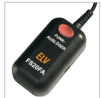
Bild 14: Die Tastkappe wird von zwei Leuchtdioden zum Aufleuchten gebracht.
