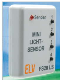
Bild 4: Überraschung! Der winzige batteriebetriebene Lichtsensor FS20 LS reagiert auf Lichteinfall.
