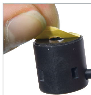
Bild 5: Ein doppelseitiger Schaumstoff-Klebering mit einer Öffnung in der Mitte für den Opto-Empfänger wird an der Gehäuseunterseite angebracht.
