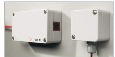
Bild 3: Sendet, sobald jemand die bis zu 20 m überbrückende Lichtschranke unterbricht – die FS20 IRL
