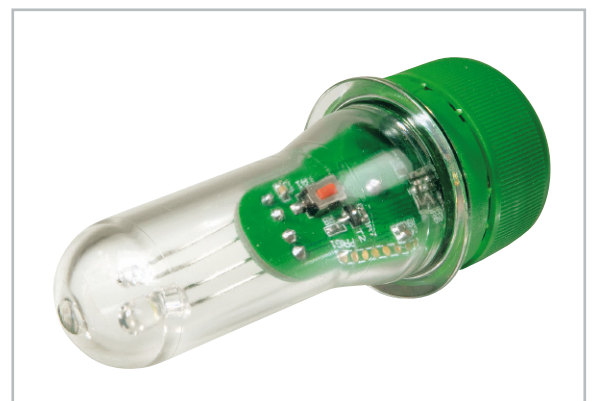
Bild 7: Das fertig montierte aktive Katzenauge
