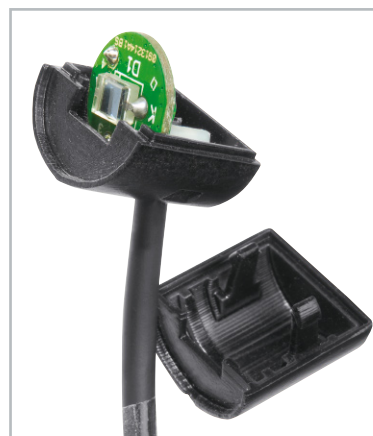
Bild 4: So wird die Platine in die dafür vorgesehene Gehäusenut gelegt.
