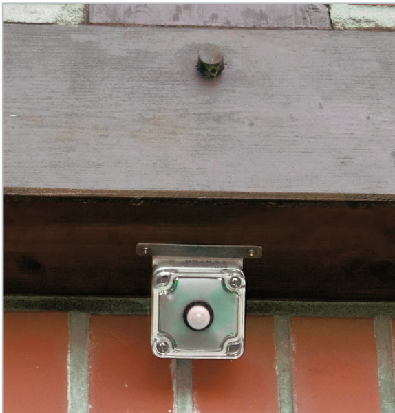
Bild 3: FS20 PIRA für die Steuerung der Rundumbeleuchtung
