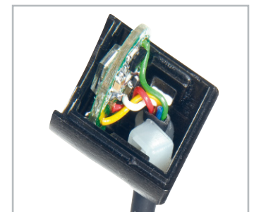
Bild 4: So wird die Platine in die dafür vorgesehene Gehäusenut gelegt.
