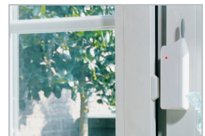
Bild 7: Einbrecherfalle: Der Tür-/Fenster-Kontakt FS20 TFK überwacht das Öffnen von Fenstern, Türen, Klappen, Schubfächern ....
