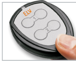
Bild 1: Die zur Auslösung des FS20 FA wohl am meisten eingesetzte Fernbedienung, die kompakte Handfernbedienung FS20 S4
