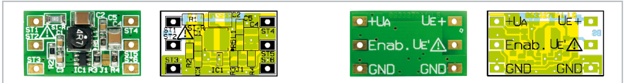
Platinenbilder mit Bestückungsdruck: links von der Oberseite, rechts von der Unterseite (Darstellung vergrößert auf 115 %)
